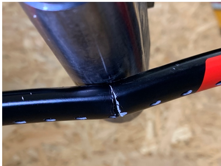
Slika 27. Pukotina na ispitnom tijelu 3
