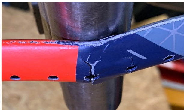
Slika 29. Pukotina na ispitnom tijelu 4
