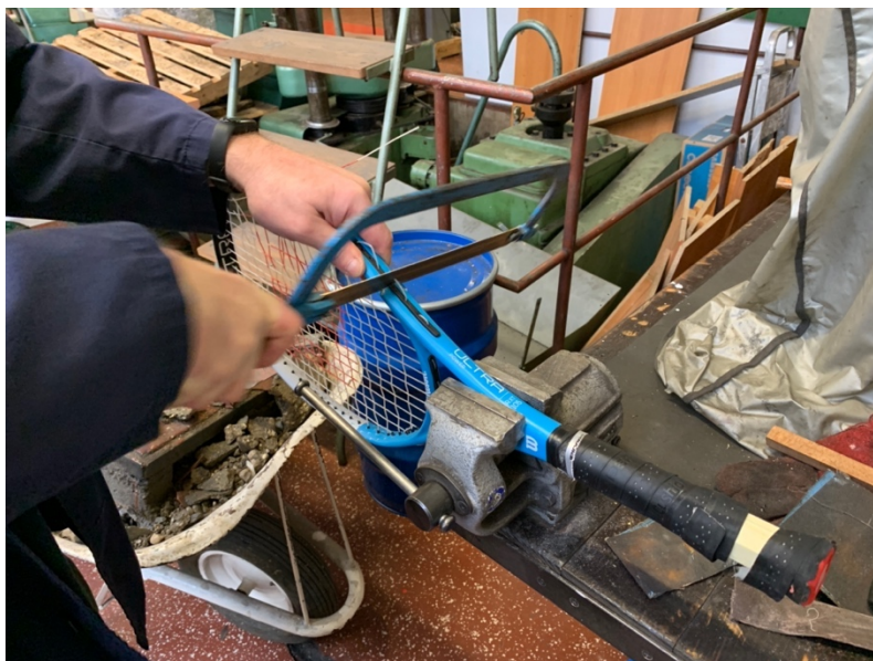
Slika 16. Rezanje ispitnih tijela iz teniskih reketa ručnom pilom
