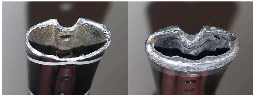
**Slika 22. Presjek ispitnog tijela 1 dalje (lijevo) i bliže (desno) od vrata reketa**
