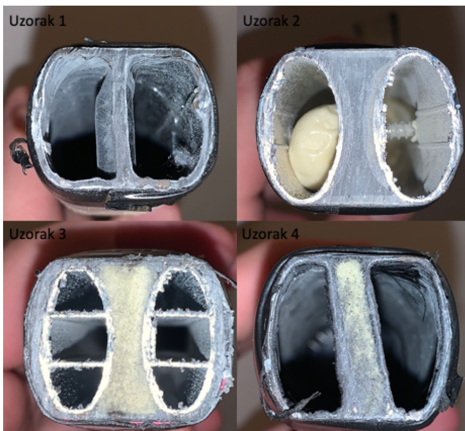
Slika 30. Poprečni presjeci ručki reketa
