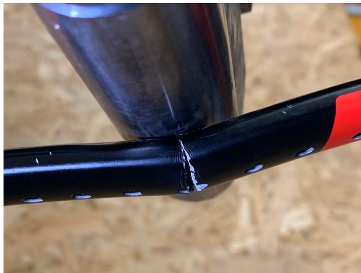
Slika 27. Pukotina na ispitnom tijelu 3
