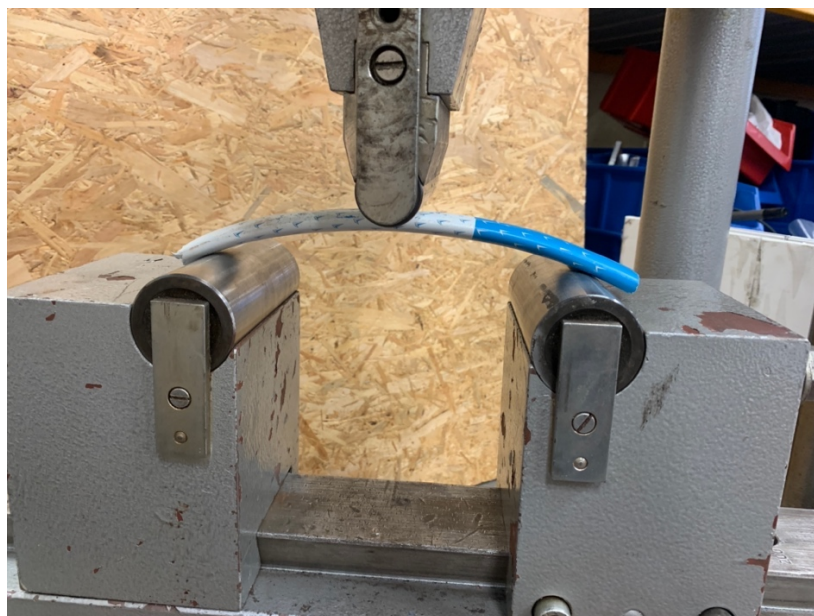
Slika 14. Univerzalna kidalica s trnom i osloncima u zahvatu s ispitnom tijelom
