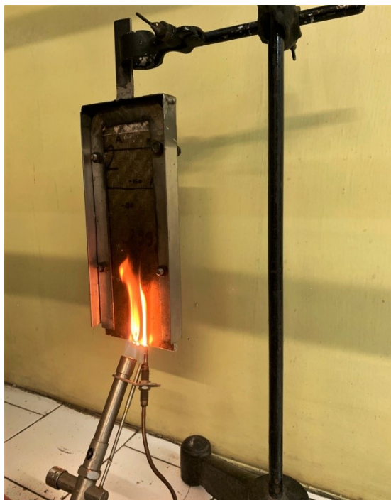
Slika 29. Početak ispitivanja paljenjem ruba ispitnog tijela
