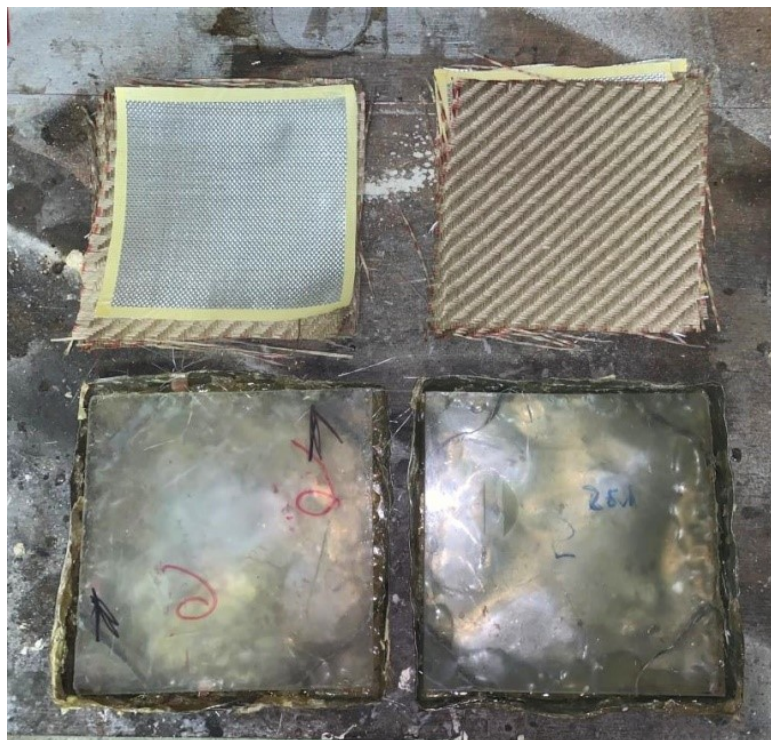
Slika 25. Priprema kompozita za ispitivanje gorivih svojstava
