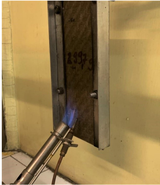
Slika 31. Početak ispitivanja paljenjem površine ispitnog tijela
