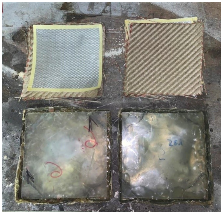
Slika 25. Priprema kompozita za ispitivanje gorivih svojstava
