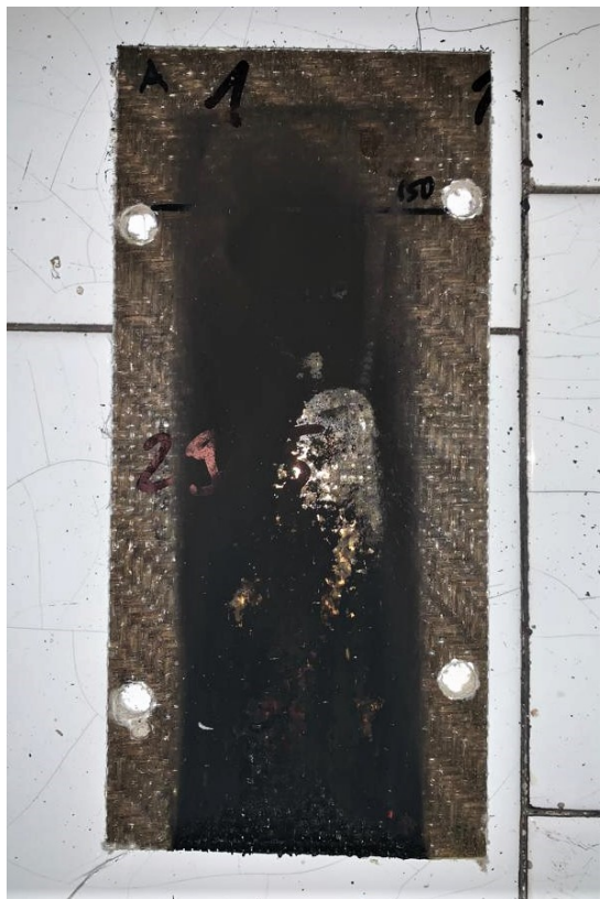
Slika 38. Rezultati ispitivanja ispitnog tijela 1 nakon izlaganja ruba plamenu
