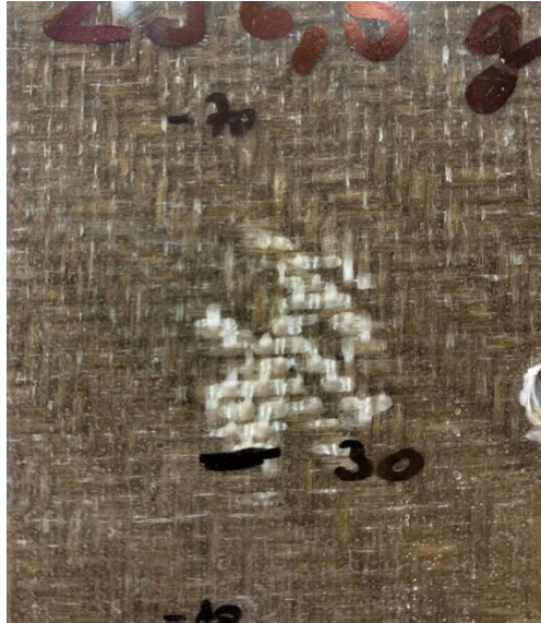
Slika 40. Rezultati ispitivanja ispitnog tijela 1 nakon izlaganja površine plamenu
