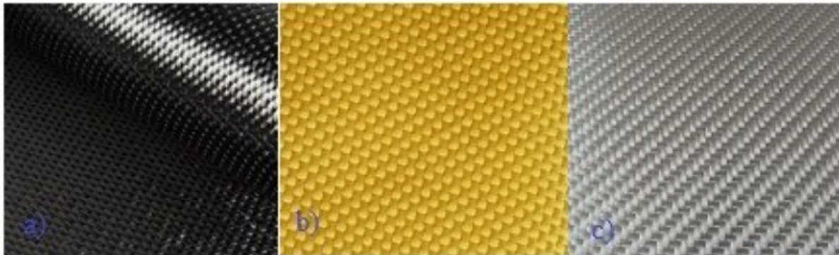
Slika 3. (a) ugljična, (b) aramidna, (c) staklena vlakna [8]
