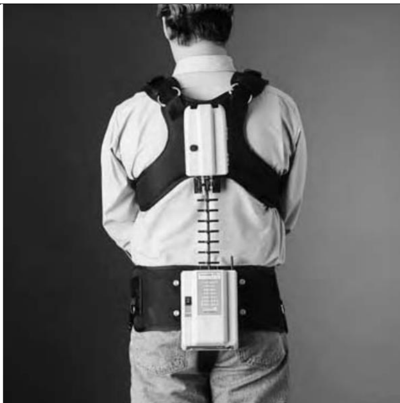
Slika 17. Uređaj za praćenje pokreta leđa – LMM [12]
