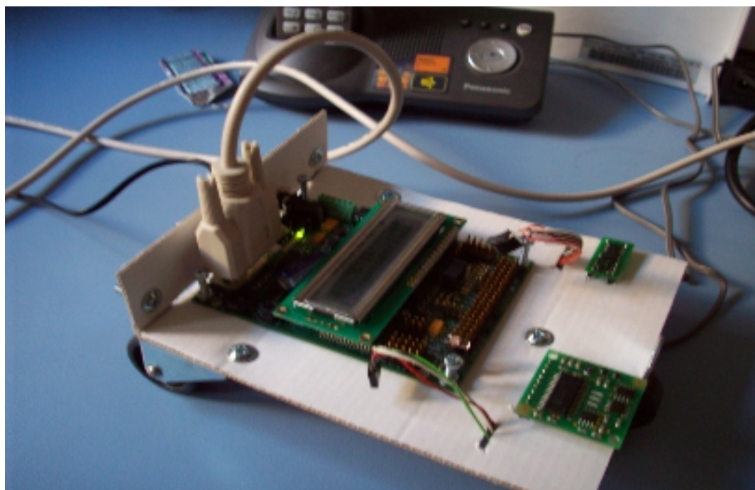
Slika 30 Model inercijalne navigacije
