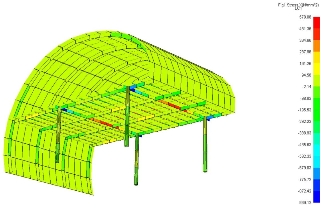
Slika 12. Ukupna aksijalna i savojna naprezanja u prirubicama jakih poprečnih nosača za LC1
