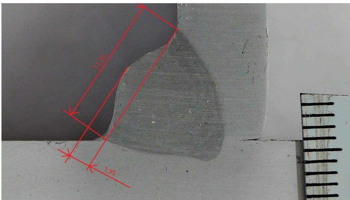
**Slika 37. Vrijednosti nadvišenja zavara uzorka 4.**
