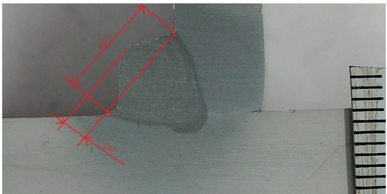
**Slika 40. Vrijednosti nadvišenja zavara uzorka 5.**
