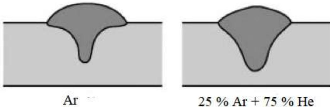
**Slika 15. Utjecaj zaštitnog plina na geometriju zavara [1]**
