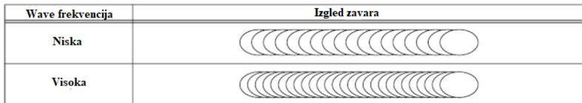
**Slika 14. Utjecaj wave pulse načina rada na izgled zavara [19]**
