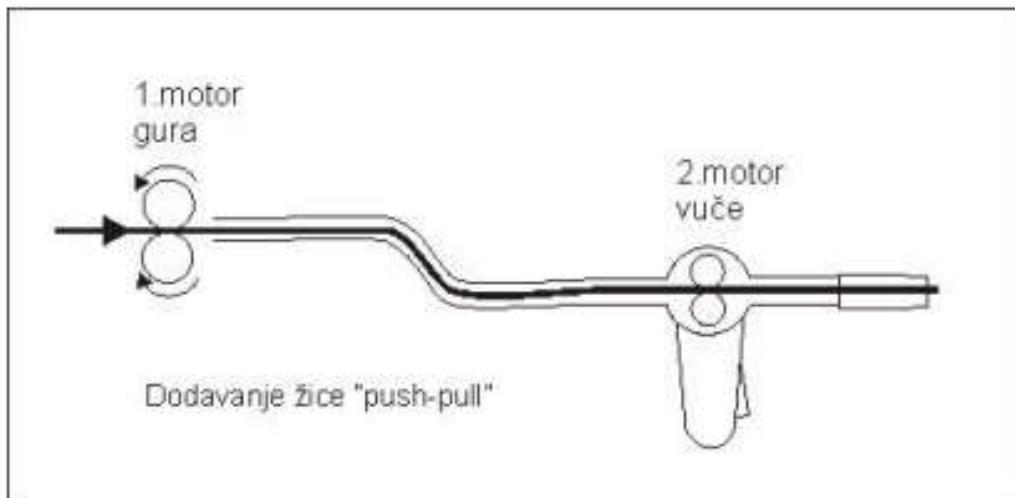
**Slika 8. Push - pull sustav za dovod žice [2]**
