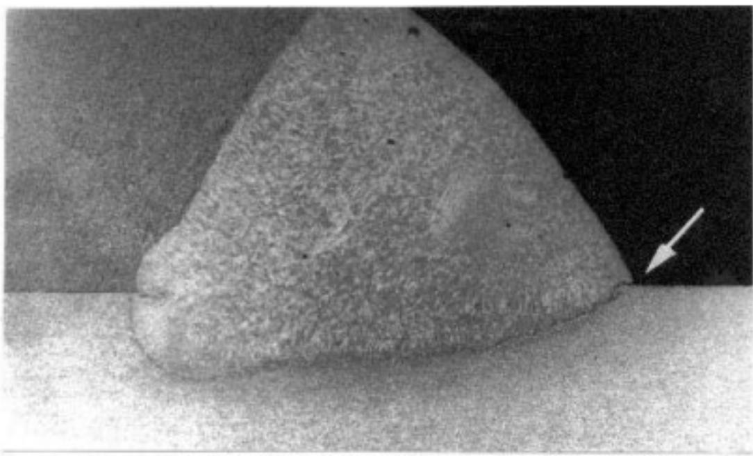
**Slika 22. Oksidni film u kutnom zavaru [1]**
