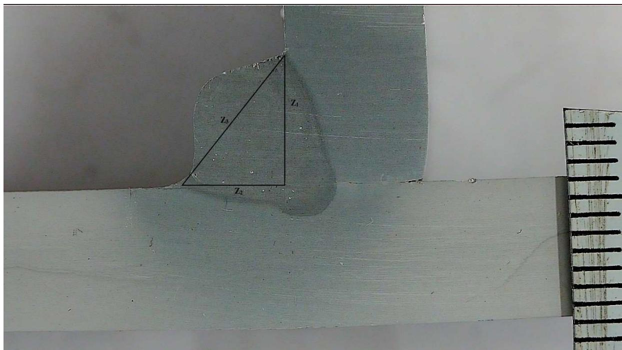
Slika 39. Geometrija zavara uzorka 5.
