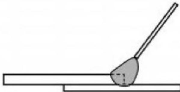
**Slika 19. Zavarivanje preklopnog spoja različitih debljina [10]**
