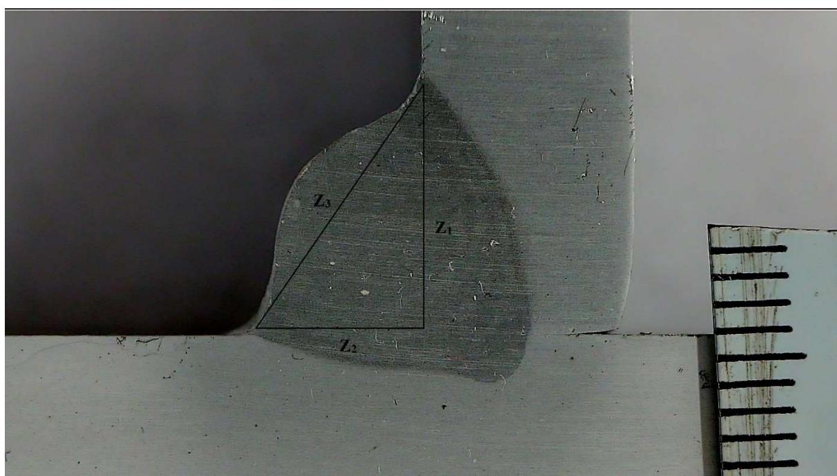
**Slika 36. Geometrija zavara uzorka 4.**
