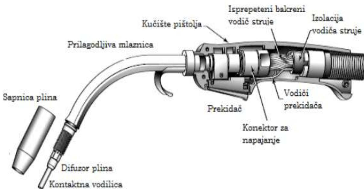
Slika 6. Zrakom hlađen pištolj za MIG zavarivanje [15]
