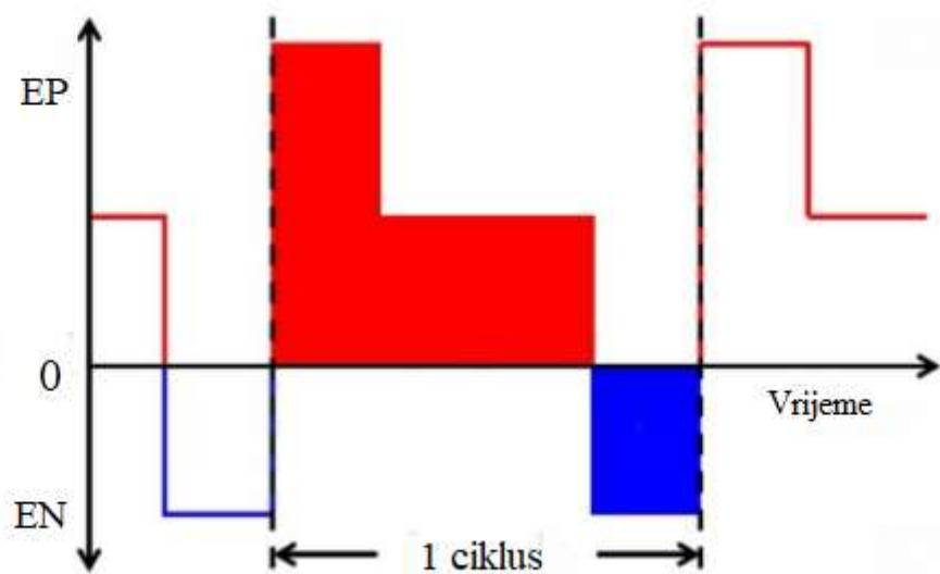
**Slika 9. Valni oblik struje za AC MIG [17]**
