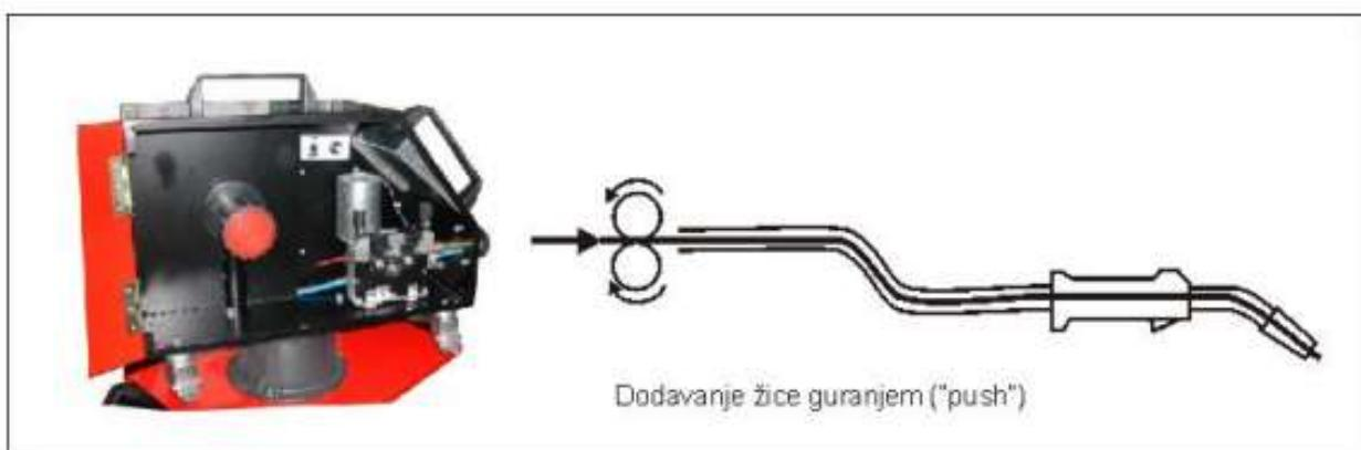
**Slika 7. Push sustav za dovod žice [2]**
