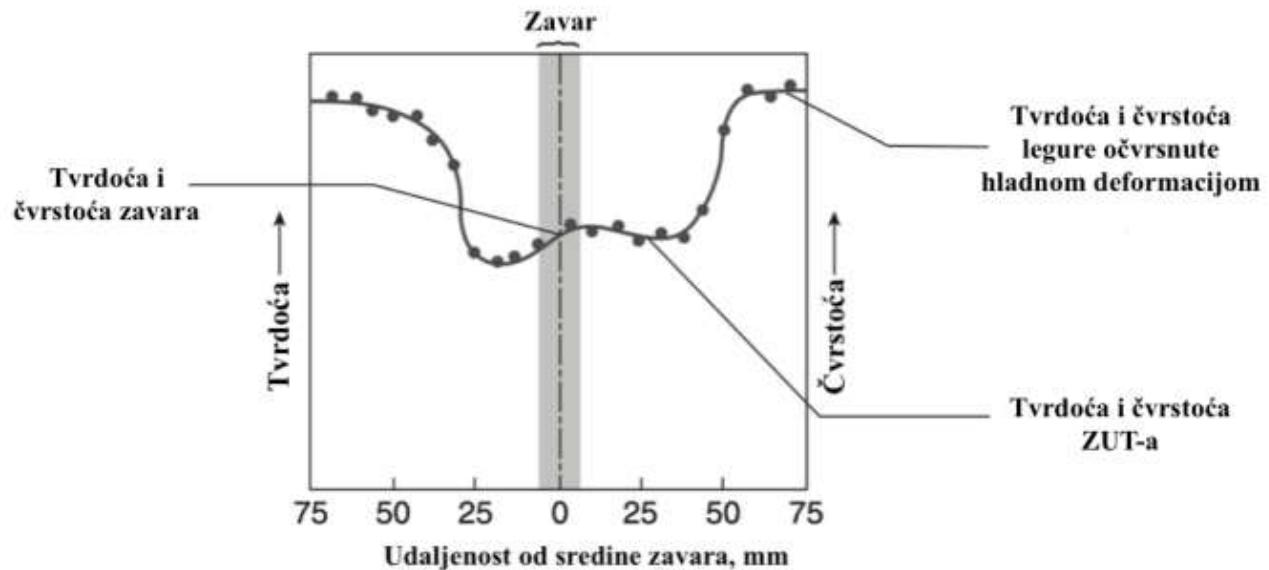
Slika 25. Utjecaj zavarivanja na hladno očvrsnute aluminijeve legure [1]
