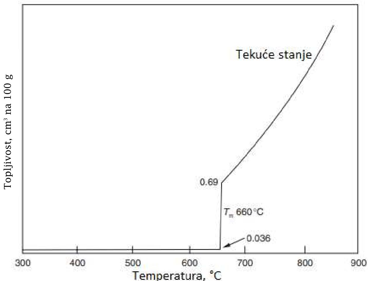
Slika 20. Topljivost vodika u aluminiju i aluminijevim legurama [1]
