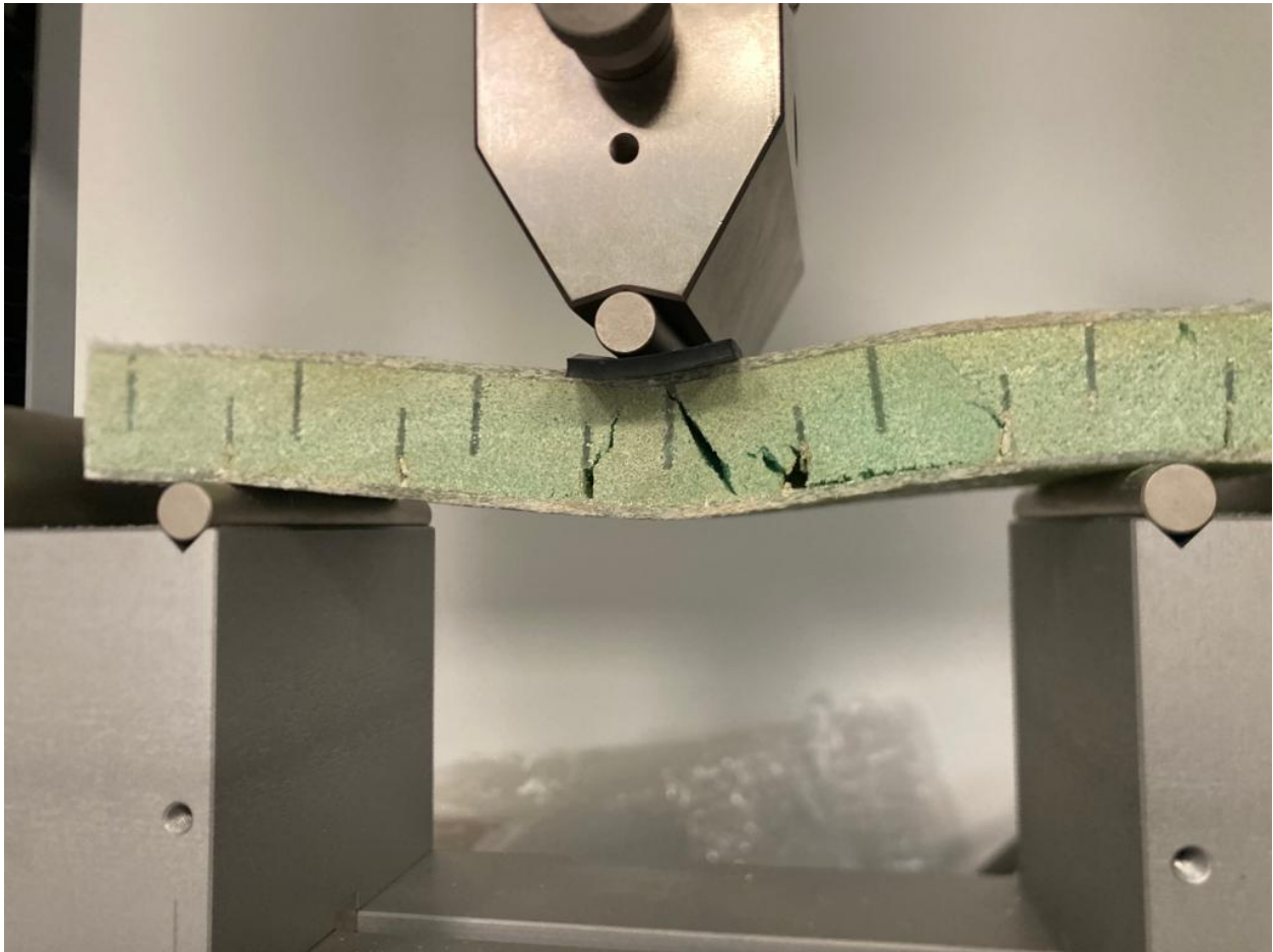
Slika 5.11 Ispitno tijelo debljeg sendviča nakon ispitivanja
