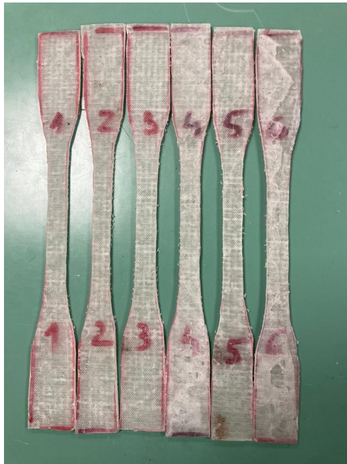
Slika 5.2 Izrezana ispitna tijela kore sendviča
