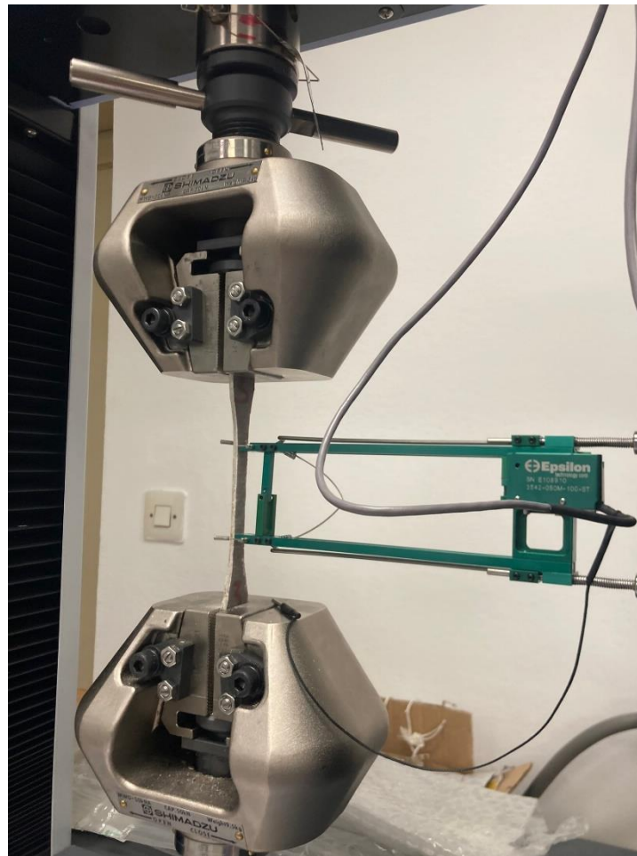
Slika 5.3 Opterećeno ispitno tijelo kore sendvič kompozita
