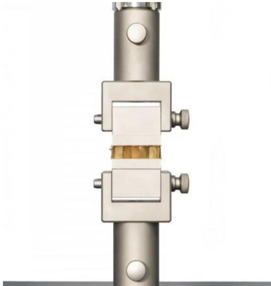
Slika 3.2 Rastezno ispitivanje sendviča okomito na slojeve ojačanja [10]
