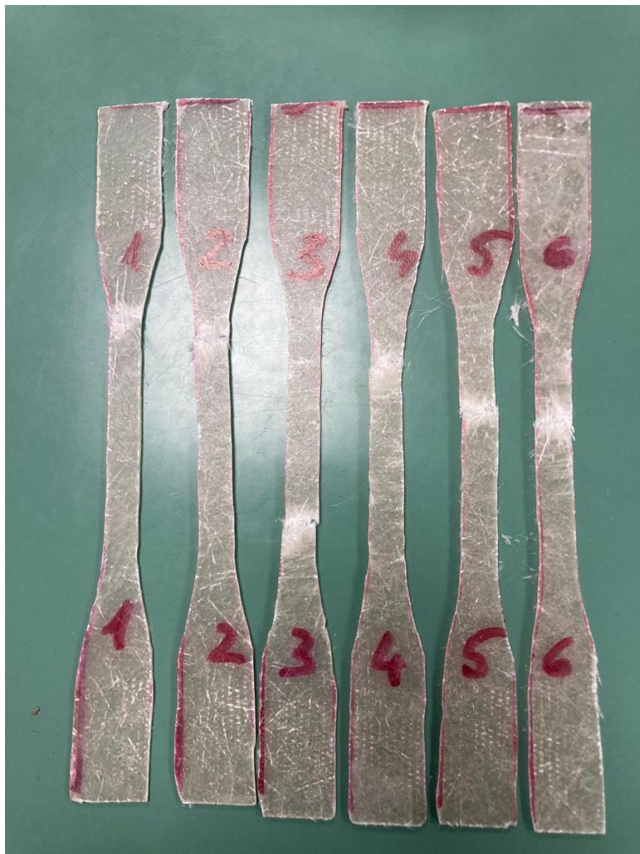
**Slika 5.8 Ispitna tijela kore sendvič kompozita nakon ispitivanja**
