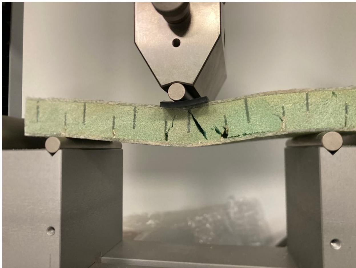
Slika 5.11 Ispitno tijelo debljeg sendviča nakon ispitivanja
