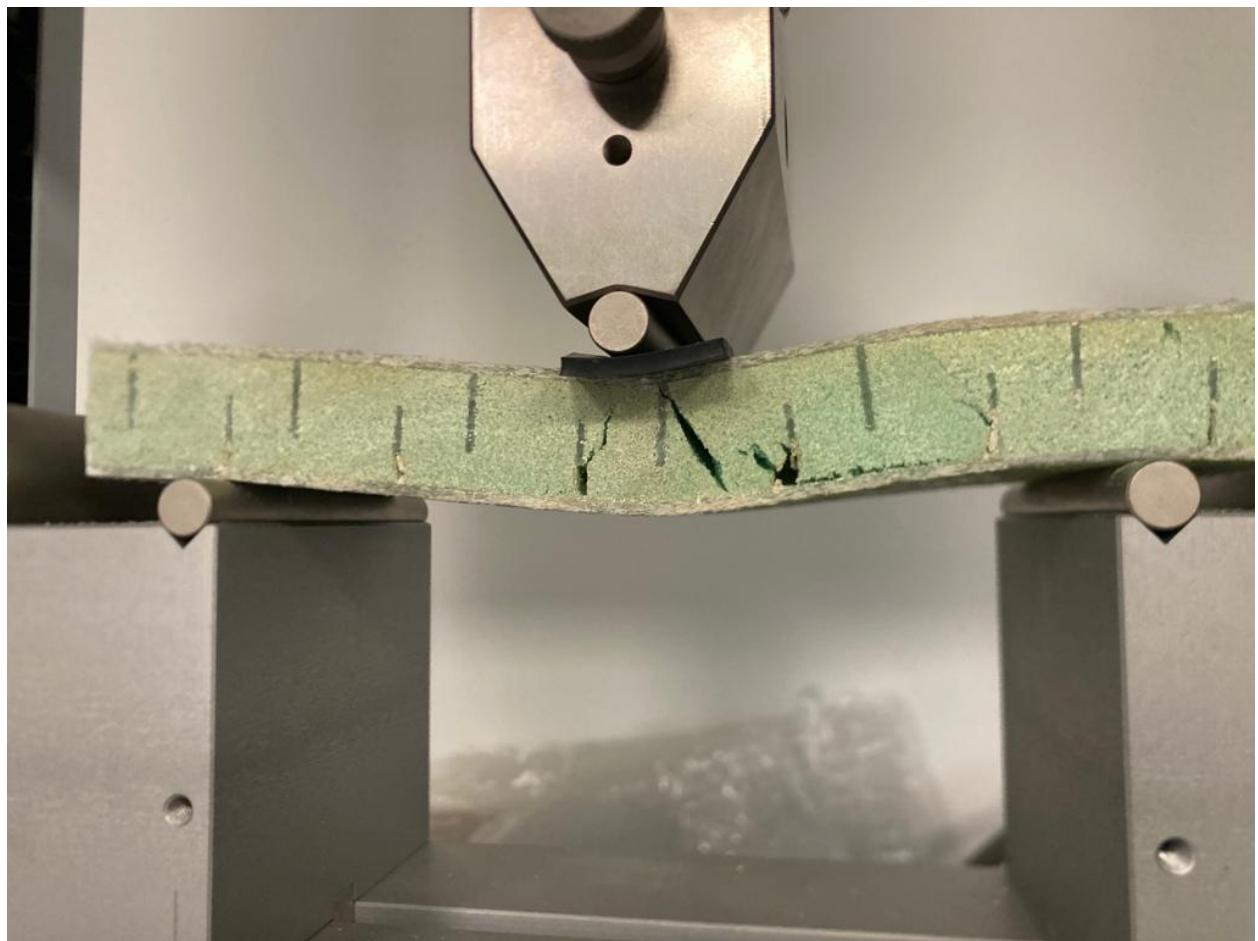
**Slika 5.11 Ispitno tijelo debljeg sendviča nakon ispitivanja**
