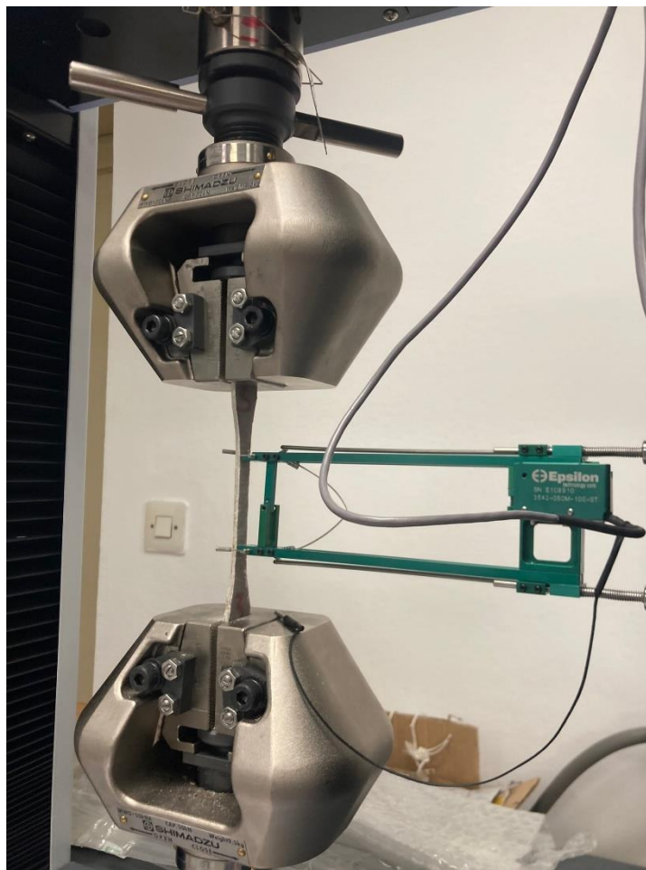
Slika 5.3 Opterećeno ispitno tijelo kore sendvič kompozita
