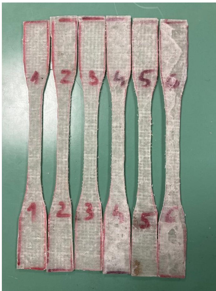
Slika 5.2 Izrezana ispitna tijela kore sendviča
