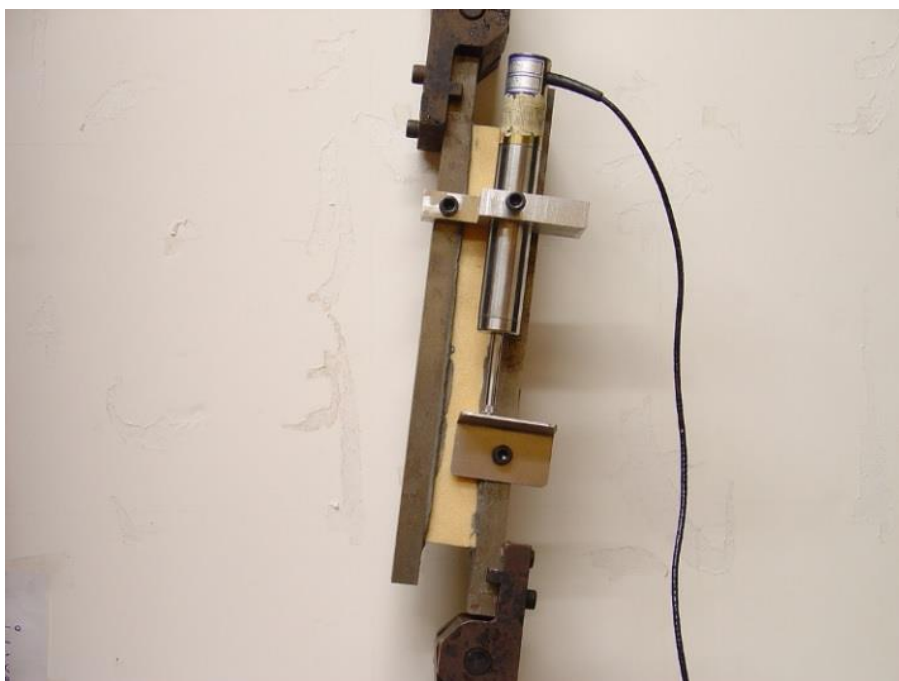
Slika 4.1 Ispitivanje jezgre sendviča prema ASTM C273 [3]
