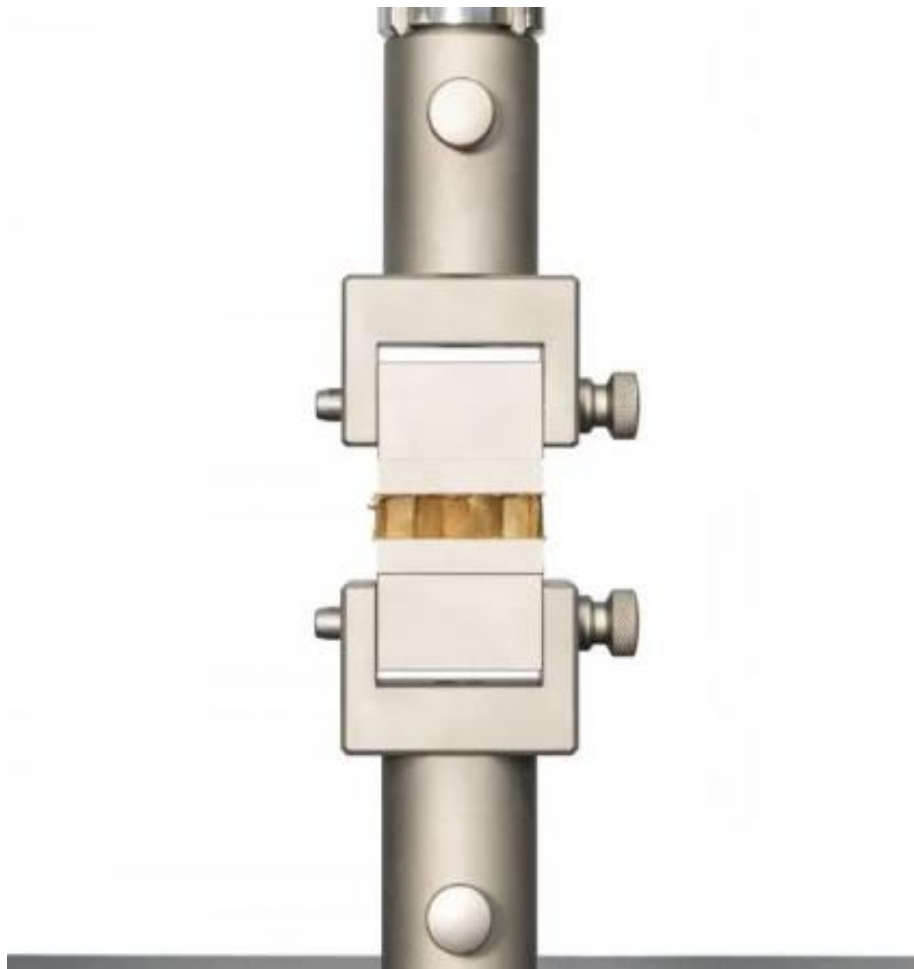
Slika 3.2 Rastezno ispitivanje sendviča okomito na slojeve ojačanja [10]
