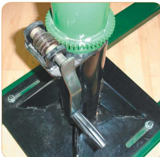
Slika 13. Okretanje sustavom zupčanika [10]
