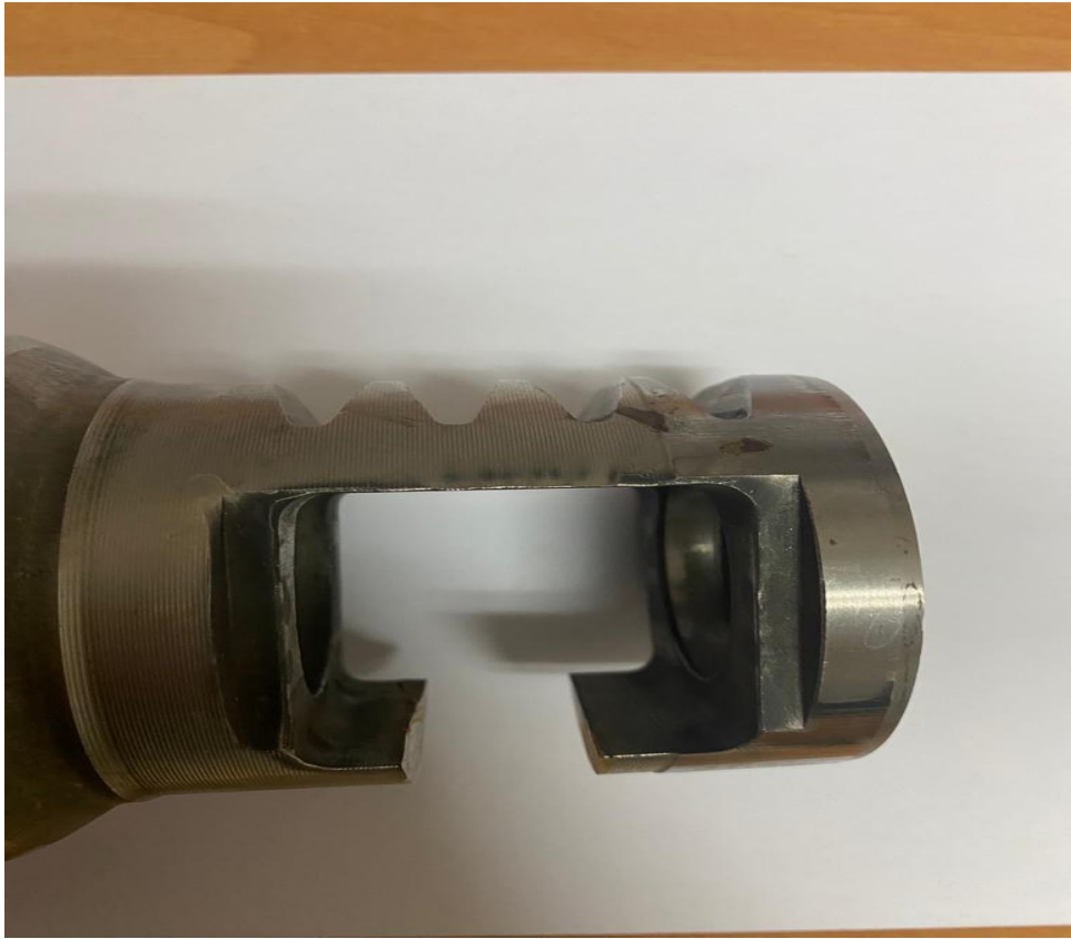
Slika 6. Ozubljenje glave volana
