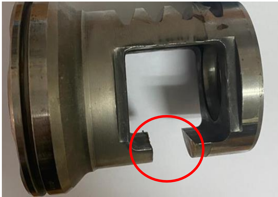
Slika 11. Izrezano ozubljenje glave volana
