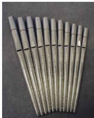
Slika 15. Olovne cijevi za orgulje [24]
