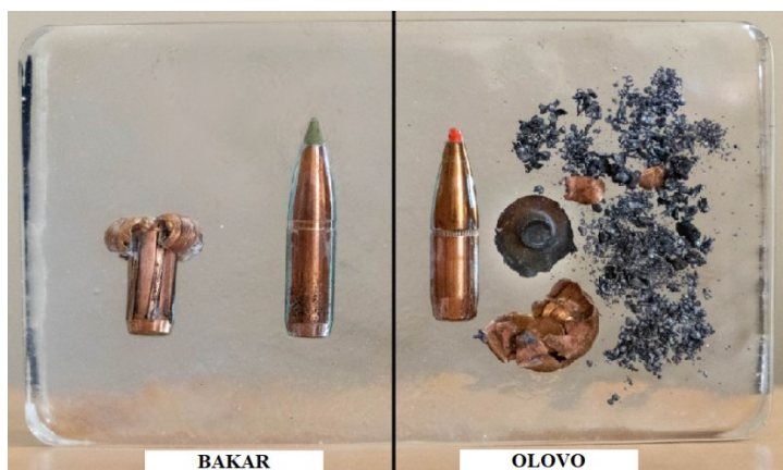
Slika 17. Bakreno i olovno streljivo prije i nakon pogotka u metu [26]
