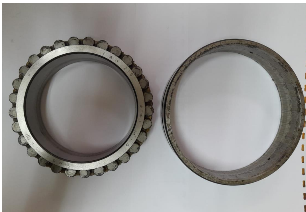
Slika 11. Rastavljen ležaj NN3020K
