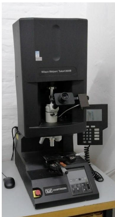
Slika 20. Tvrdomjer Wilson-Wolpert Tukon 2100B
