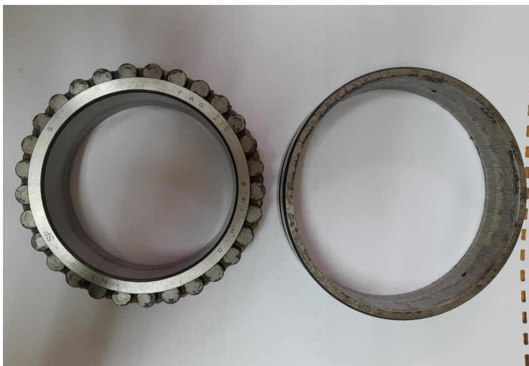
Slika 11. Rastavljen ležaj NN3020K
