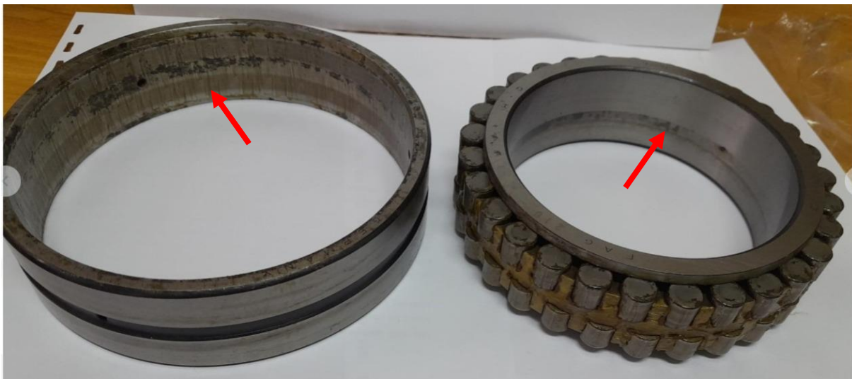
Slika 17. Tragovi trošenja ležaja
