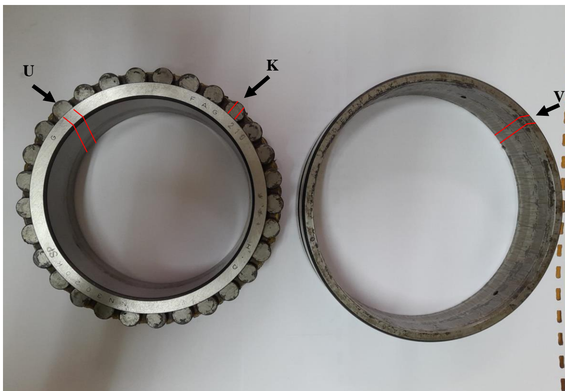
Slika 18. Mjesta rezanja dijelova ležaja
