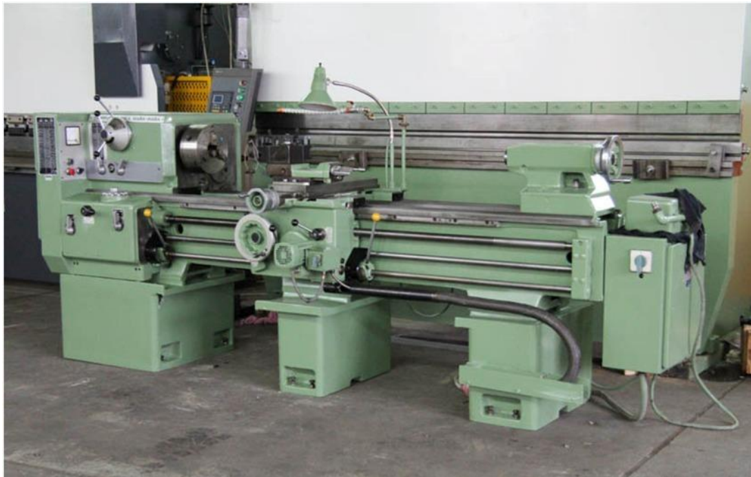
Slika 3. Tokarski stroj Boehringer D480 [5]
