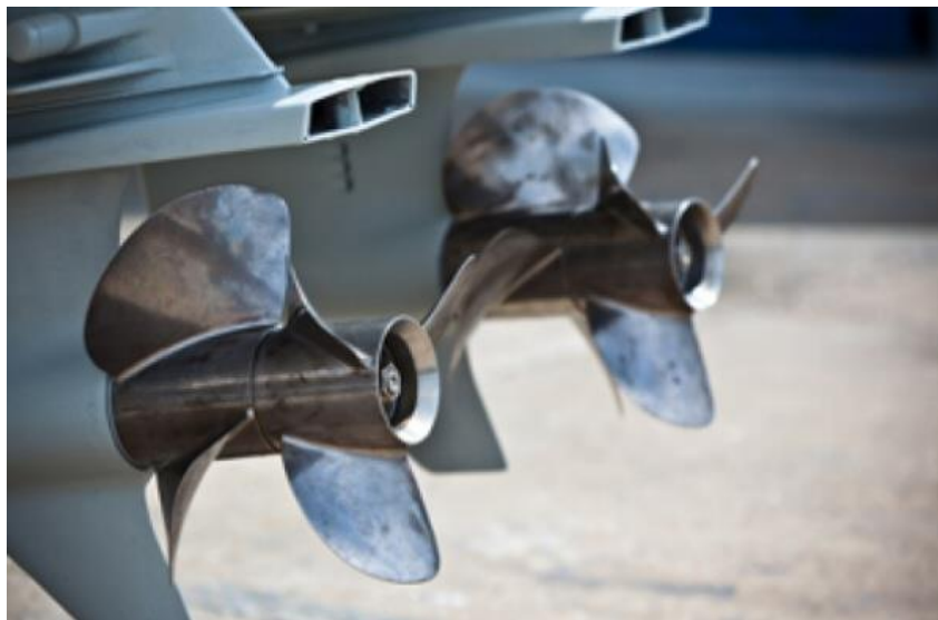
Slika 30. Brodski vijak (propeler) s dijelovima napravljenim od titanijevih legura [50]
