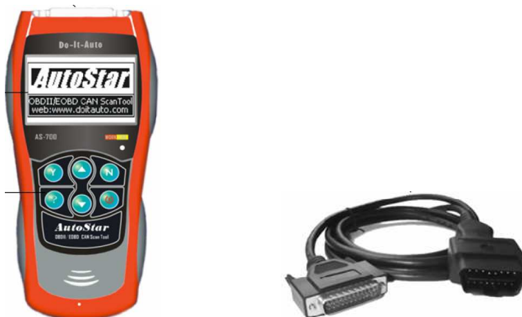
Slika 6.7. Uređaj za dijagnosticiranje AutoStar AS-700 (lijevo); Dijagnostički kabel (desno).
