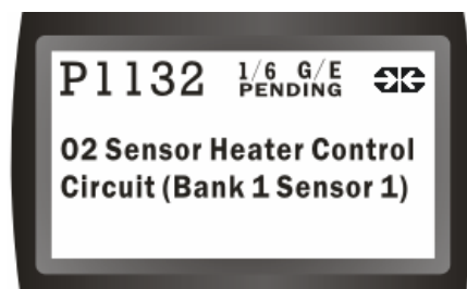
Slika 5.6. Uobičajeni izgled očitaneog koda pogreške [5].
