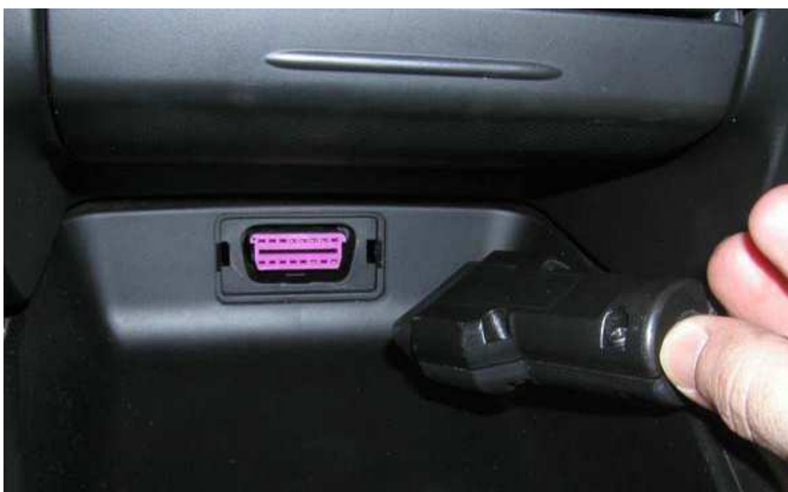
Slika 2.6. Položaj CARB priključnice na vozilu Audi A3 nalazi se dolje lijevo od kola upravljača, ispod prekidača za svjetla (fotografija je snimljena nakon što je skinut poklopac na priključnici) [1].
