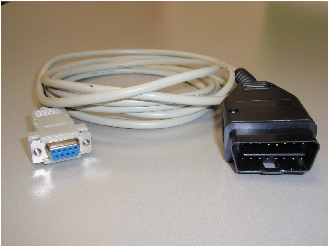
Slika 7.6. Konačni izgled spojnog kabla EOBBD – DB9 (RS232).
