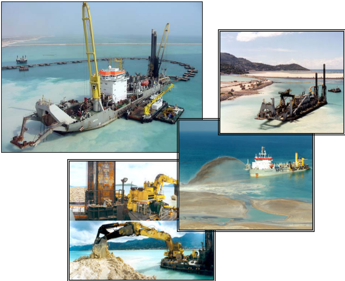
Slika 1. : Prikaz različitih tipova jaružara i raspon njihovog djelovanja
