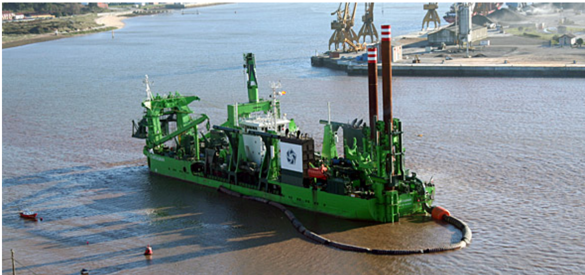
Slika 10. : Iskrcaj iskapanog tereta preko plutajućeg cjevovoda spojenog s cjevovodom za iskrcaj tereta na pramcu broda
