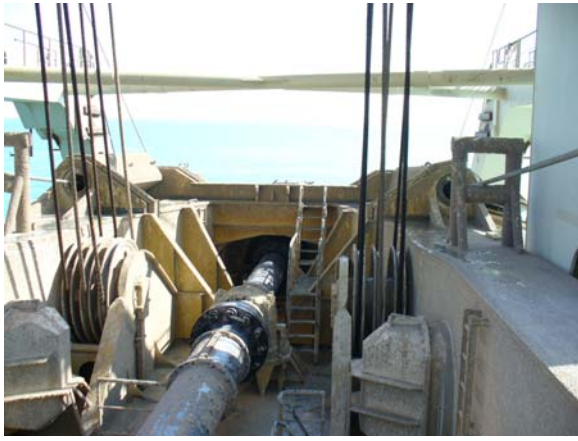
Slika 11. : Osovina kopača i užnice za kinematiku kopača
