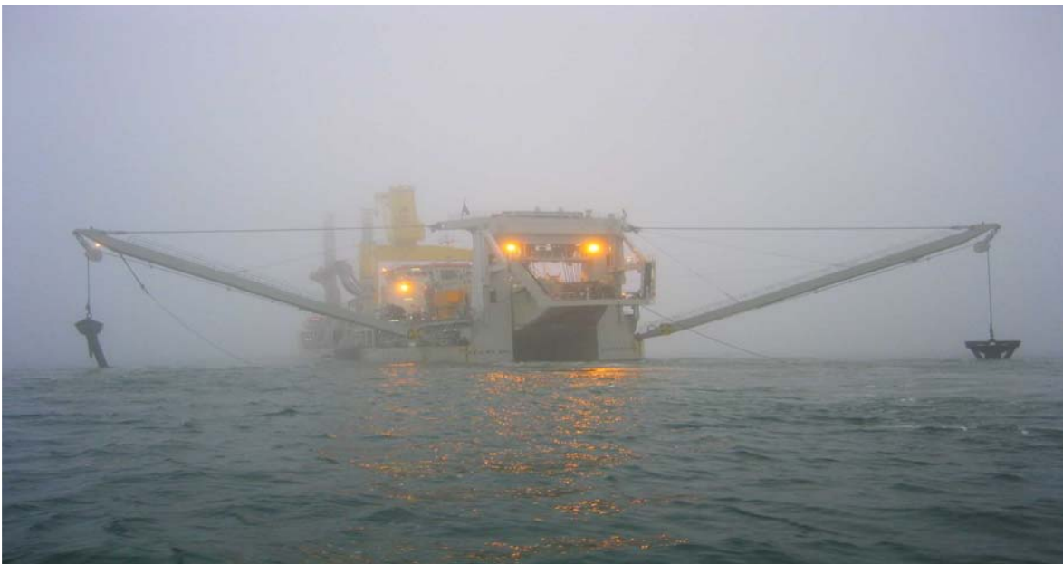
Slika 17. : Grane radnih sidara u položaju za spuštanje na poziciju za kopanje
