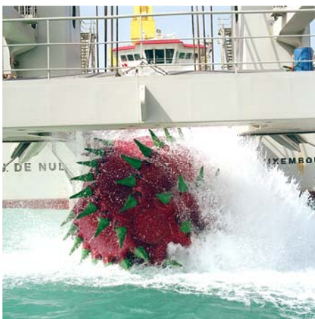
Slika 5. : Glava i radna ruka kopača u krmenom zdencu okružena radnom platformom
