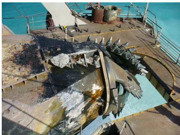
Slika 5. : Glava i radna ruka kopača u krmenom zdencu okružena radnom platformom
