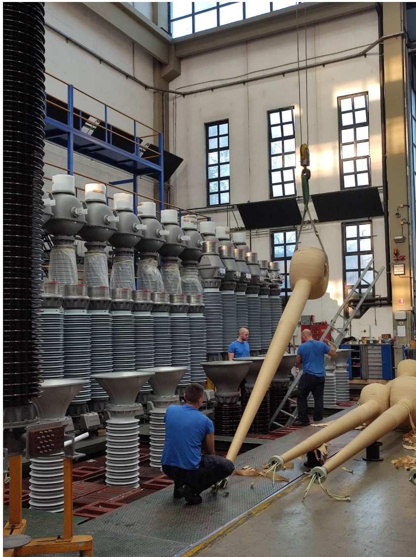
Slika 36. Ulaganje aktivnog dijela u izolator
