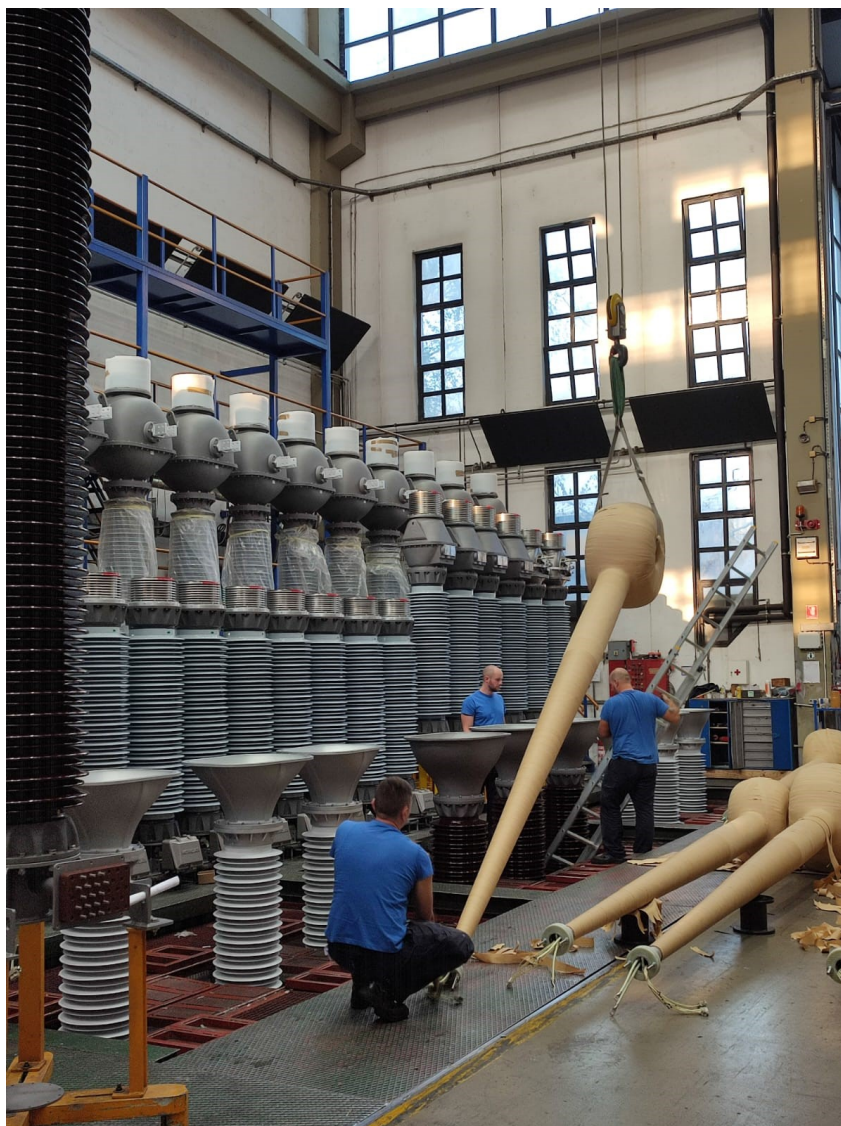
Slika 36. Ulaganje aktivnog dijela u izolator
