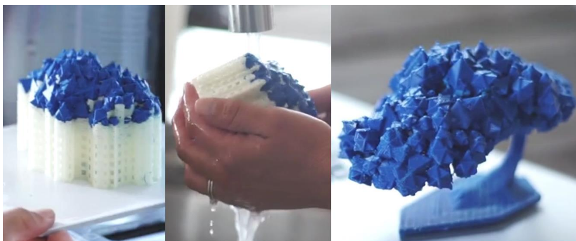
Slika 6. PVA potporni materijal otopljen vodom [1]
