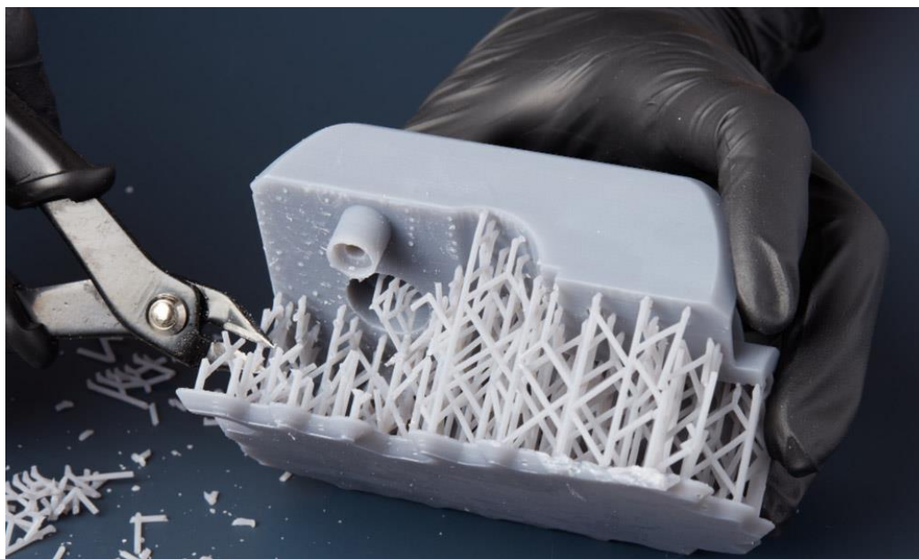
Slika 5. Ručno skidanje potpornog materijala [13]
