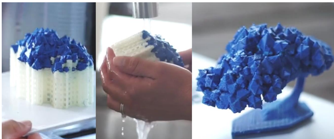
Slika 6. PVA potporni materijal otopljen vodom [1]
