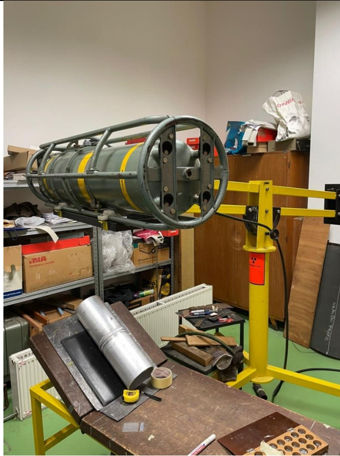
Slika 27. Priprema za radiografsko snimanje uzorka
