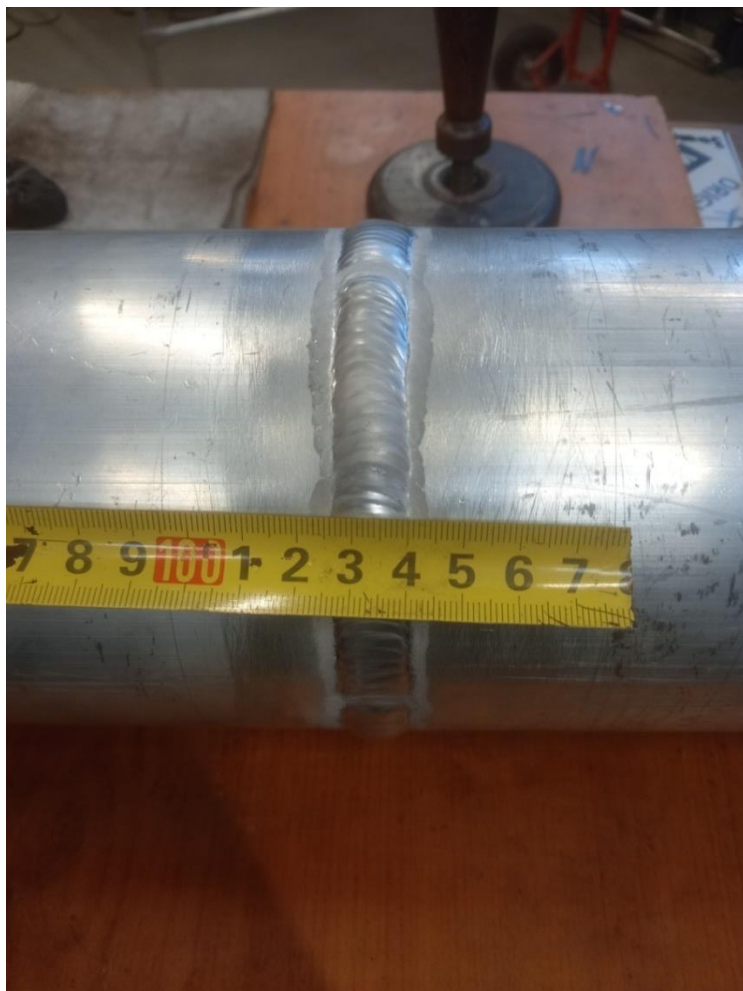
Slika 23. Izgled zavara nakon drugog prolaza
