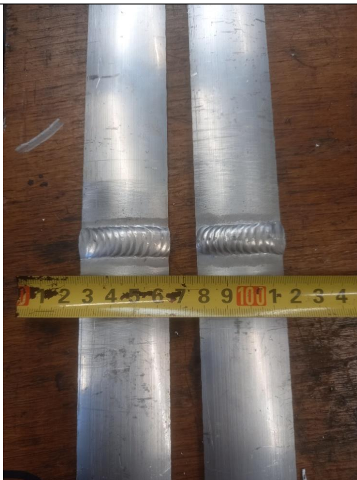
Slika 25. Uzorci za ispitivanje izrezani na tračnoj pili
