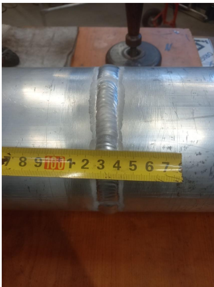
Slika 23. Izgled zavara nakon drugog prolaza
