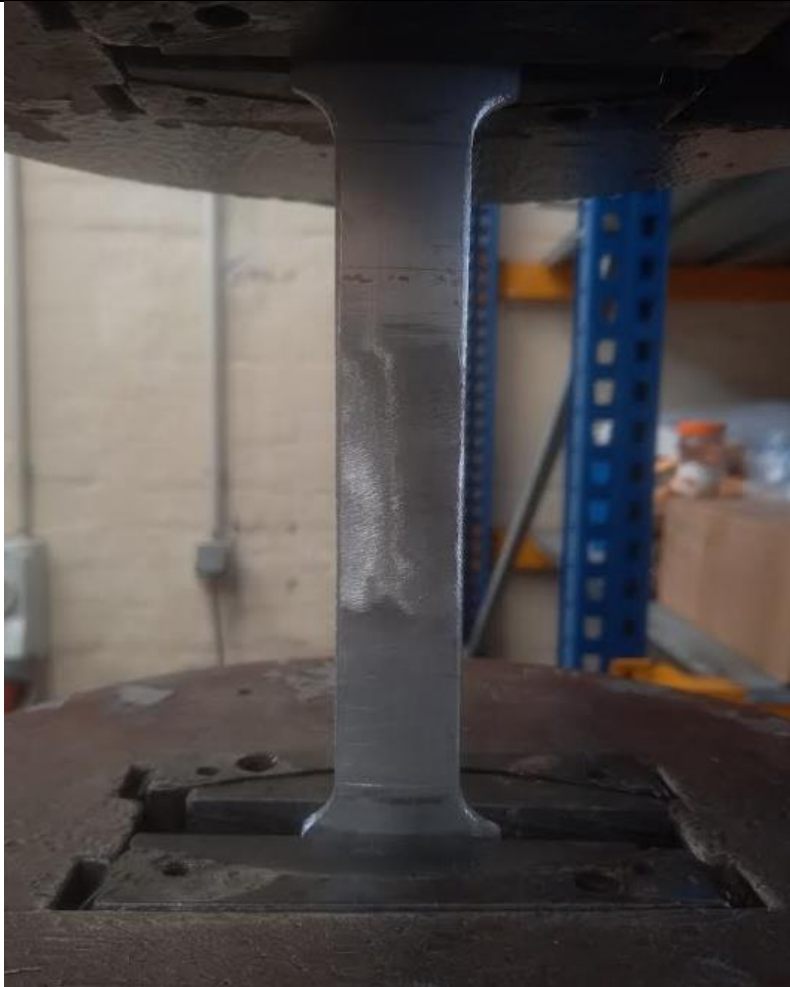
Slika 30. Epruveta ukliještena u kidalici
