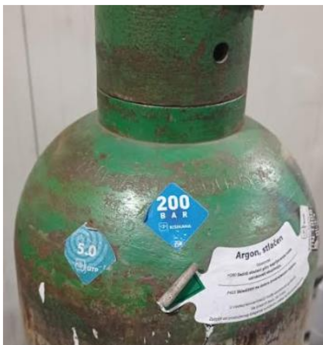
Slika 16. Boca zaštitnog plina Argon 5.0
