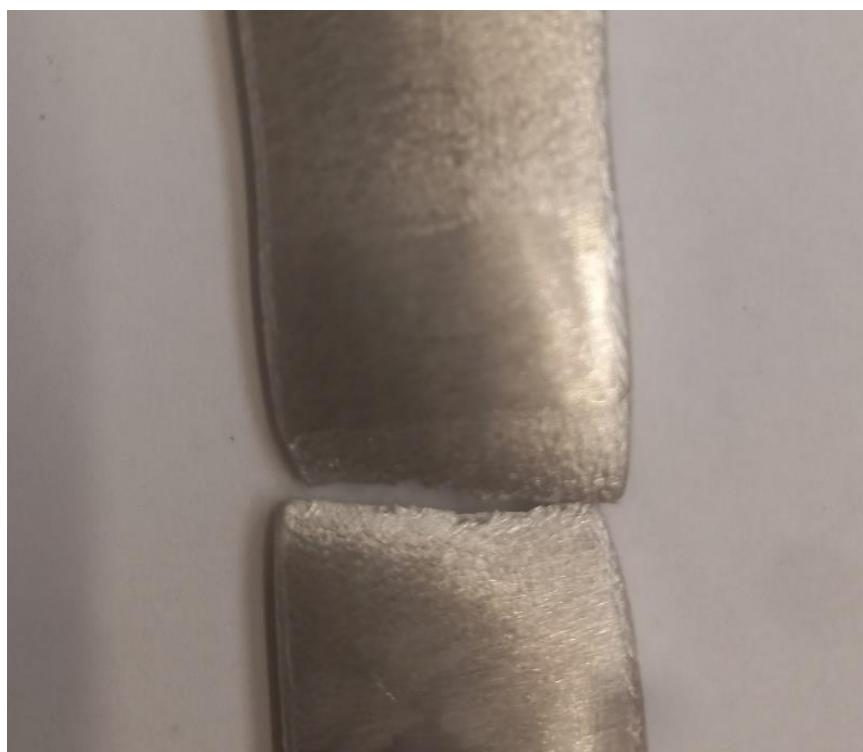
**Slika 32. Epruveta ispitana statičkim vlačnim pokusom na kidalici**
