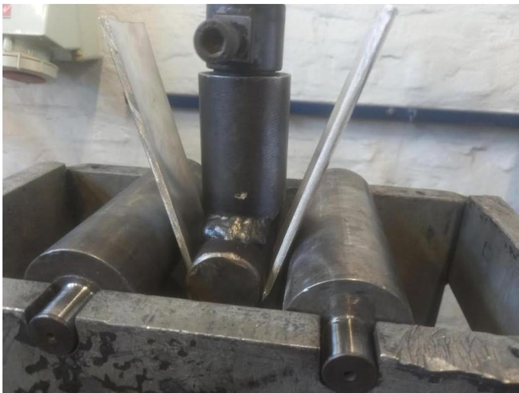
Slika 34. Prikaz ispitivanja savijanjem u Laboratoriju za zavarivanje na FSB-u
