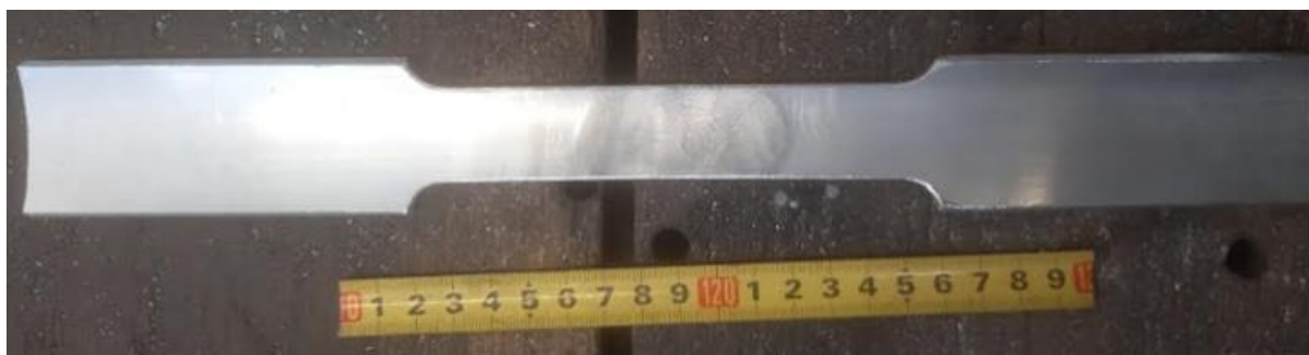
Slika 29. Epruveta za statički vlačni pokus
