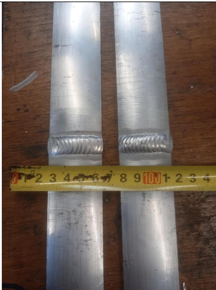
Slika 25. Uzorci za ispitivanje izrezani na tračnoj pili
