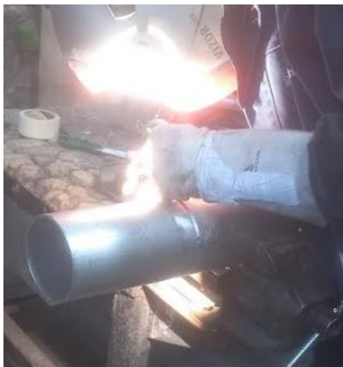
Slika 21. Zavarivanje cijevi u zavarivačkoj radionici Iskra brodogradilište Šibenik
