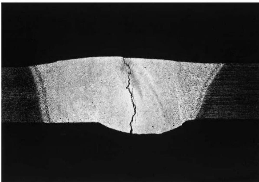
Slika 2. Prikaz tople pukotine nastale tijekom zavarivanja aluminija[5]
