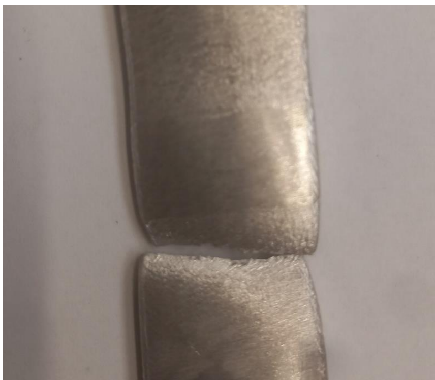
Slika 32. Epruveta ispitana statičkim vlačnim pokusom na kidalici
