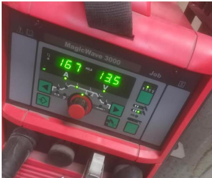
Slika 19. Parametri na aparatu za zavarivanje
