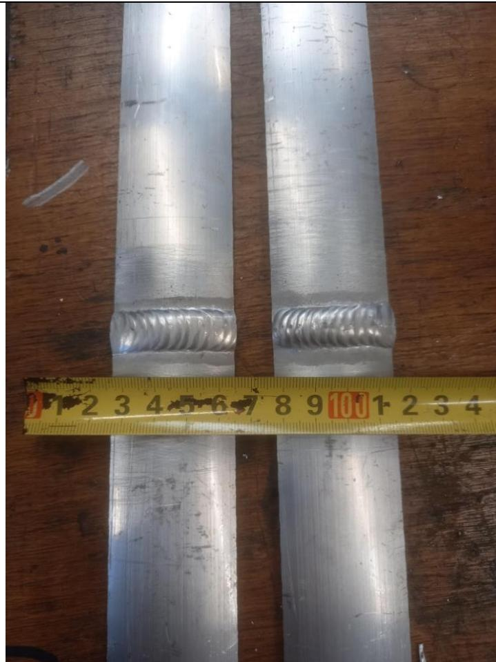
Slika 25. Uzorci za ispitivanje izrezani na tračnoj pili
