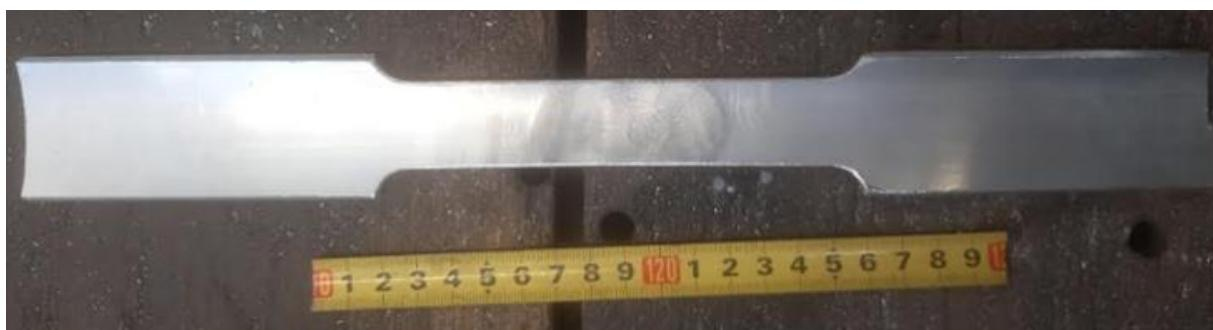
**Slika 29. Epruveta za statički vlačni pokus**
