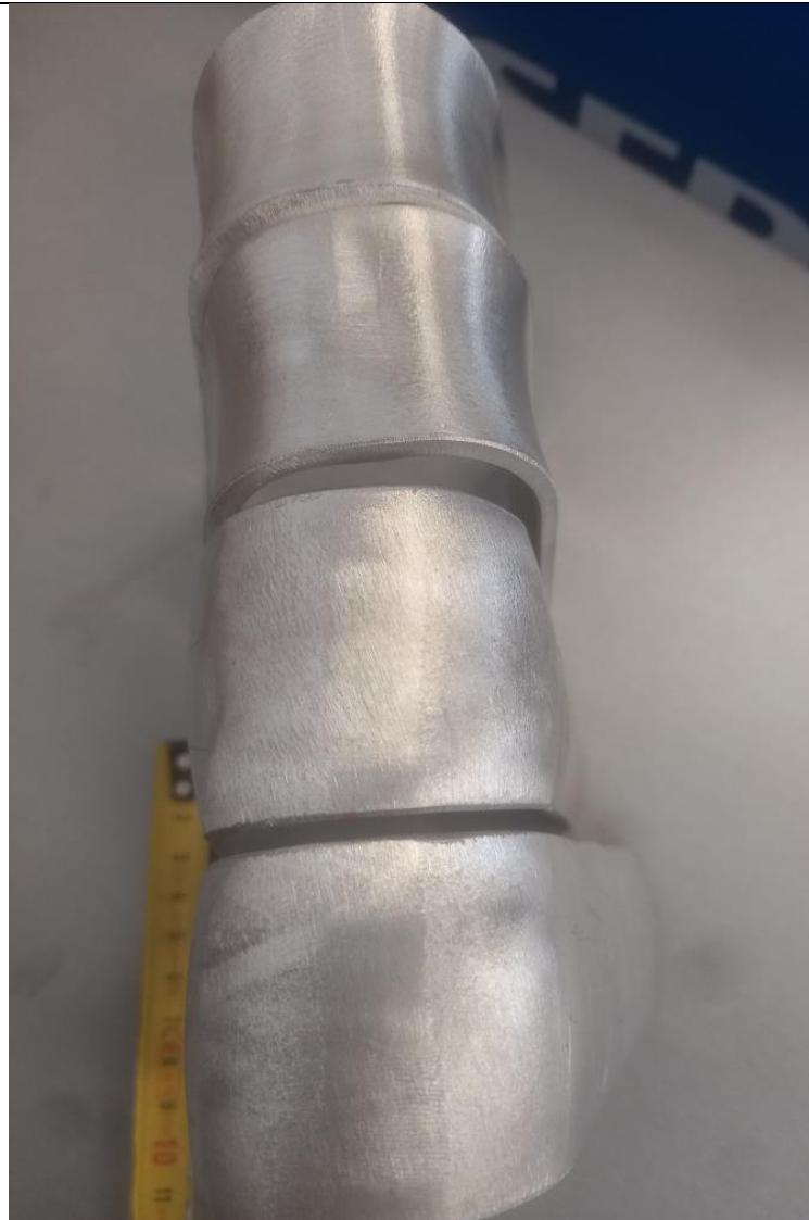
**Slika 35. Rezultati ispitivanja savijanjem**
