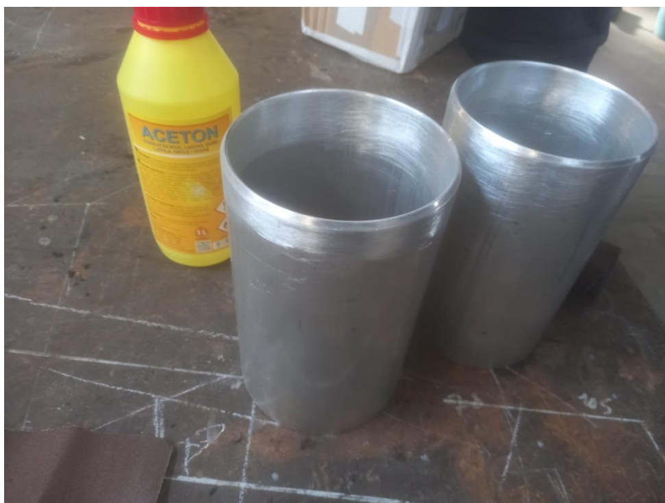
Slika18. Radni komadi nakon čišćenja
