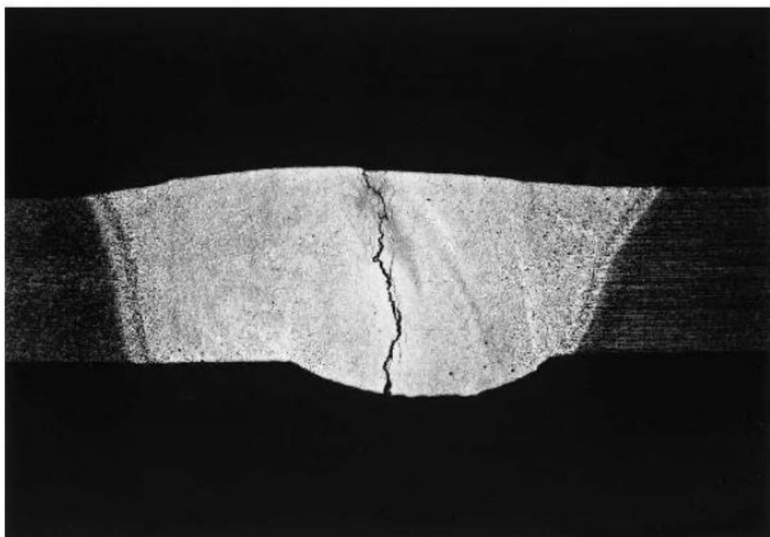
Slika 2. Prikaz tople pukotine nastale tijekom zavarivanja aluminija[5]
