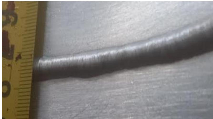
Slika 24. Prikaz korijena zavara zavarenog sa skošenjem na unutarnjem rubu cijevi
