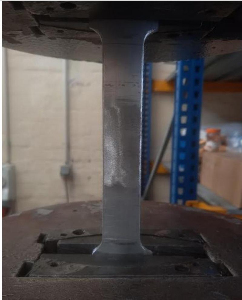
**Slika 30. Epruveta uklještena u kidalici**
