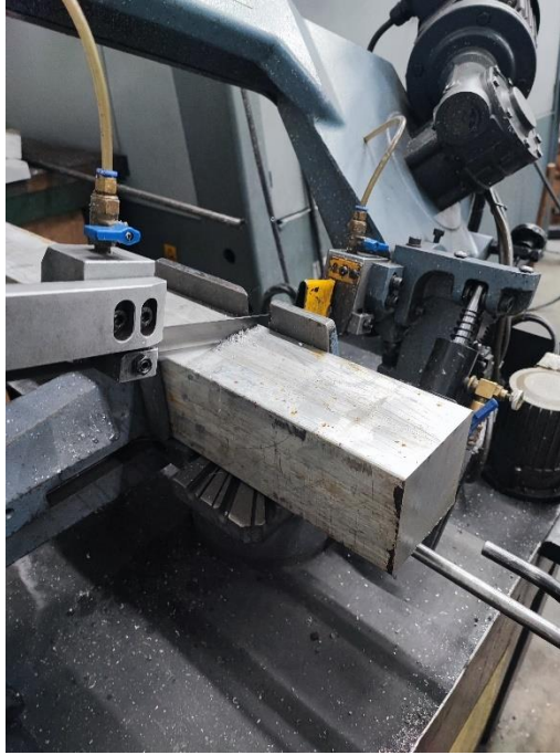
Slika 23. Rezanje sirovca na tračnoj pili
