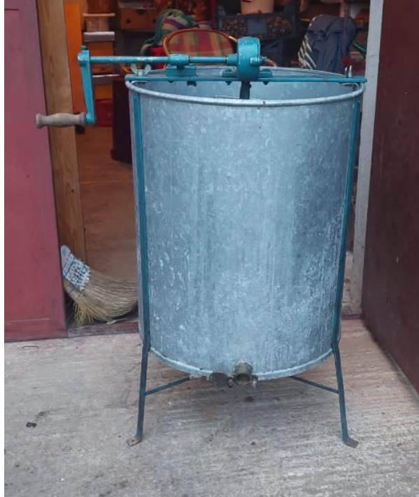
Slika 17. Klasična tangencijalna vrcaljka
