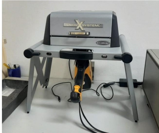
Slika 38. Olympus XRF uređaj za snimanje kemijskog sastava
