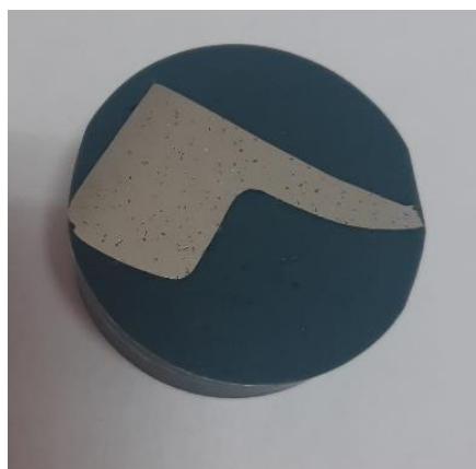
Slika 41. Izrezani uzorak kućišta u polimeru
