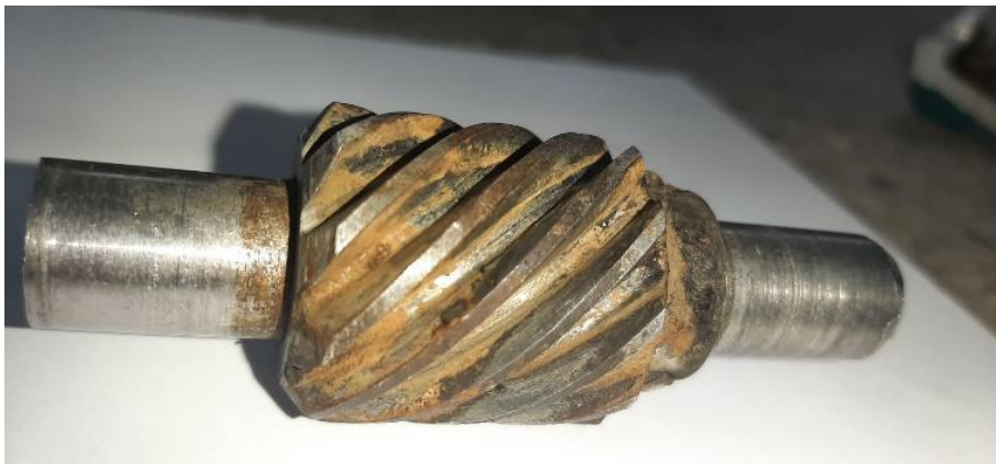
Slika 23. Vratilo vrcaljke na kojeg je ugrađen pužni vijak
