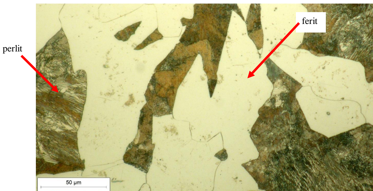
Slika 42. Mikrostruktura sredine presjeka pužnog kola, uvećana 100x
