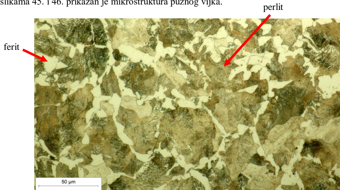
Slika 44. Mikrostruktura sredine presjeka pužnog vijka, uvećana 500x
