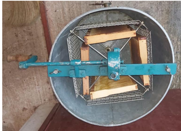
Slika 16. Položaj okvira saća u tangencijalnoj vrcaljki gledan odozgo
