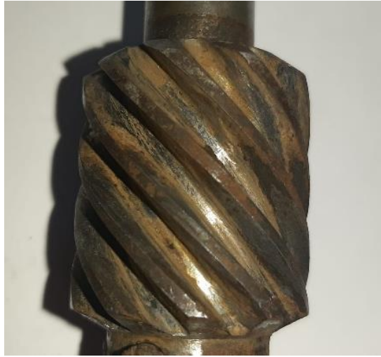
Slika 36. Pužni vijak nakon čišćenja
