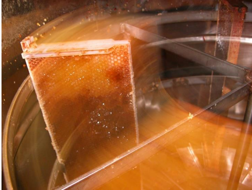
Slika 15. Položaj okvira saća u radijalnoj vrcaljki za vrijeme rotacije [14]
