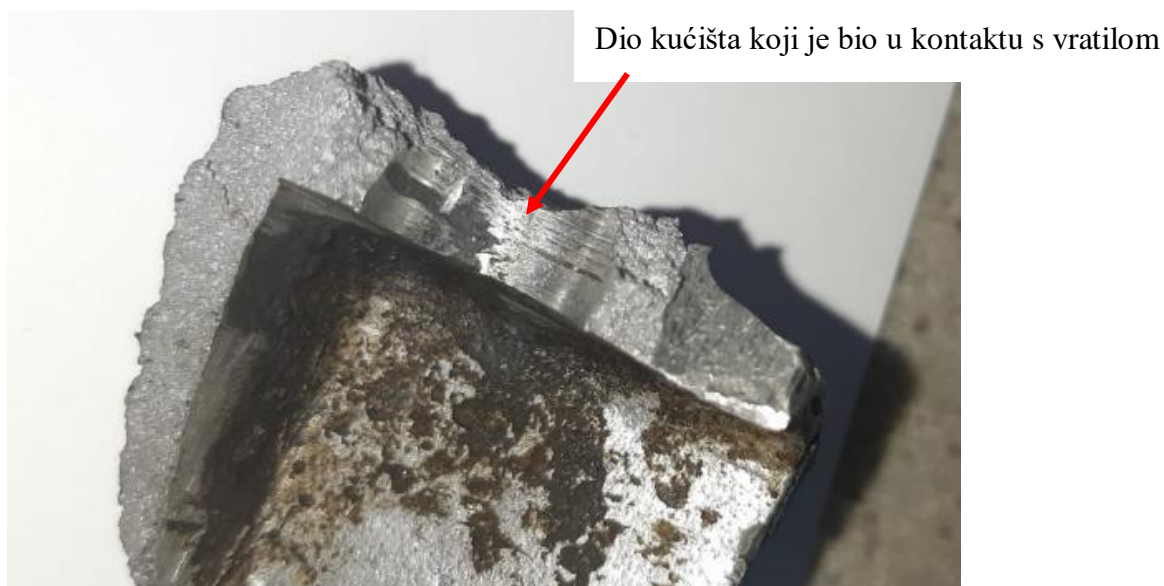
Slika 34. Izrezano kućište na mjestu kontakta s vratilom
