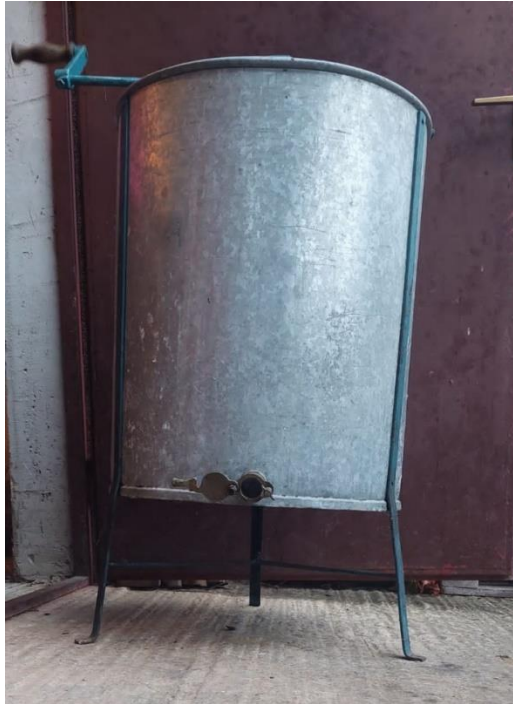
Slika 21. 3 zelene nogice spojene na bubanj vrcaljke
