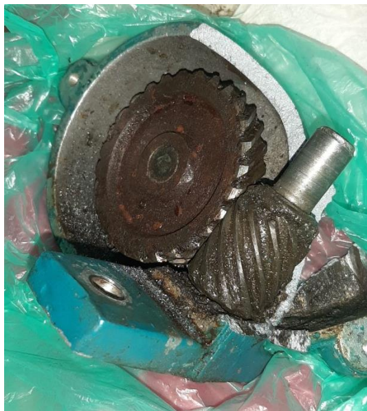
Slika 25. Pužni vijak i pužno kolo u izrezanom kućištu
