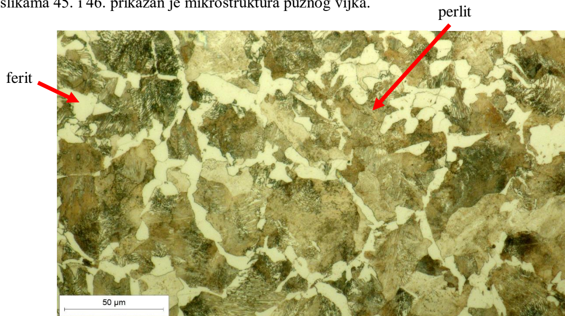
Slika 44. Mikrostruktura sredine presjeka pužnog vijka, uvećana 500x
