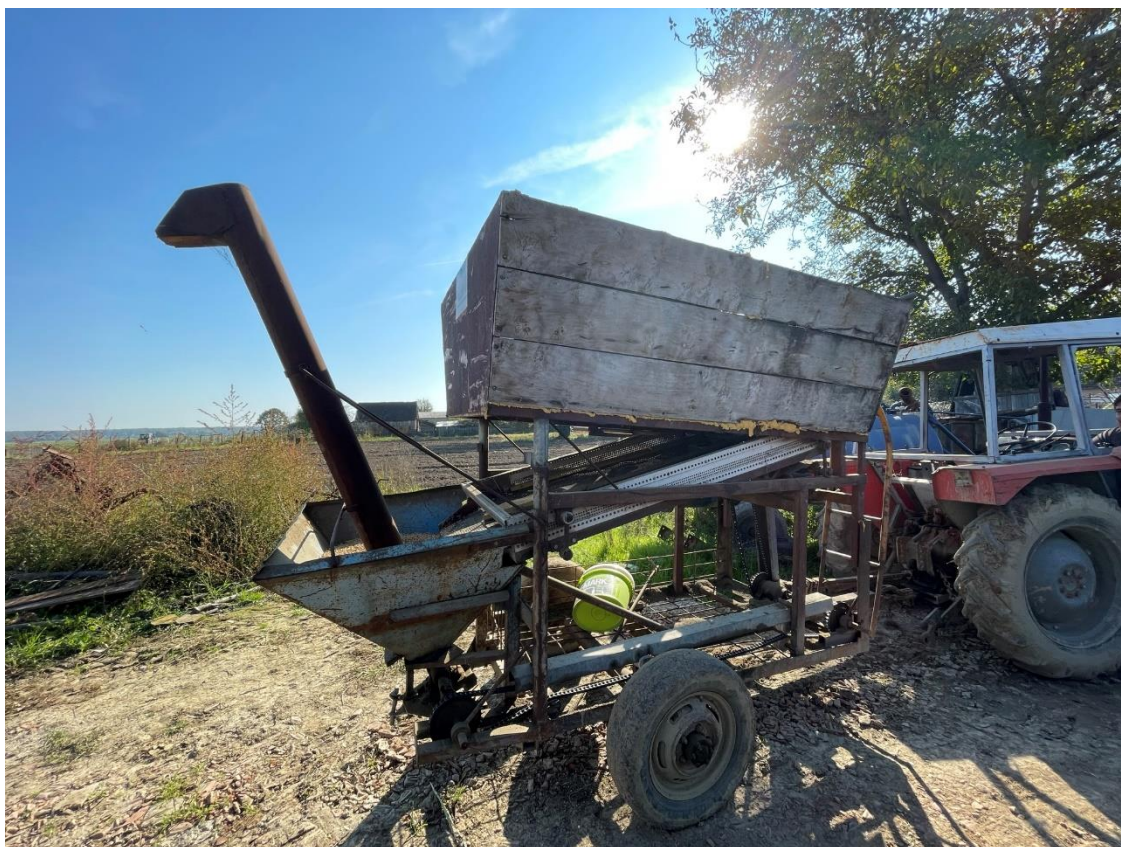
Slika 9. Primjer ručnog rađenog traktorskog priključka za prosijavanje soje
