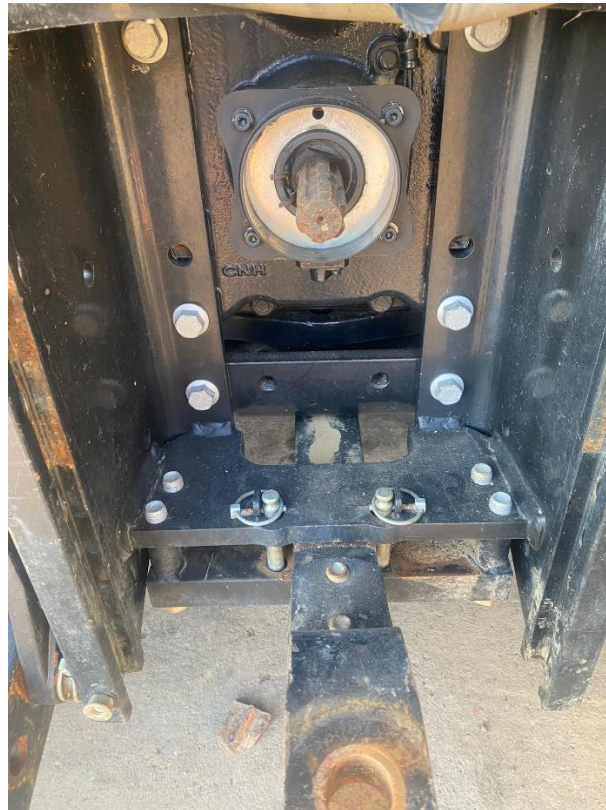
Slika 2. Izlazni priključak za radno vratilo
