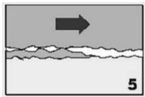
Slika 19 Adhezijsko trošenje [2]
