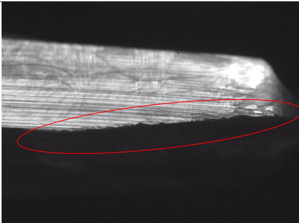
**Slika 42** Krzanje rezne oštrice 2- komercijalni alat
