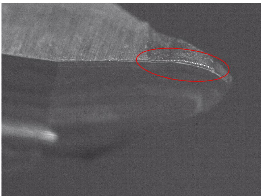
**Slika 36** Trošenje stražnje površine alata 1- NANO PRO
