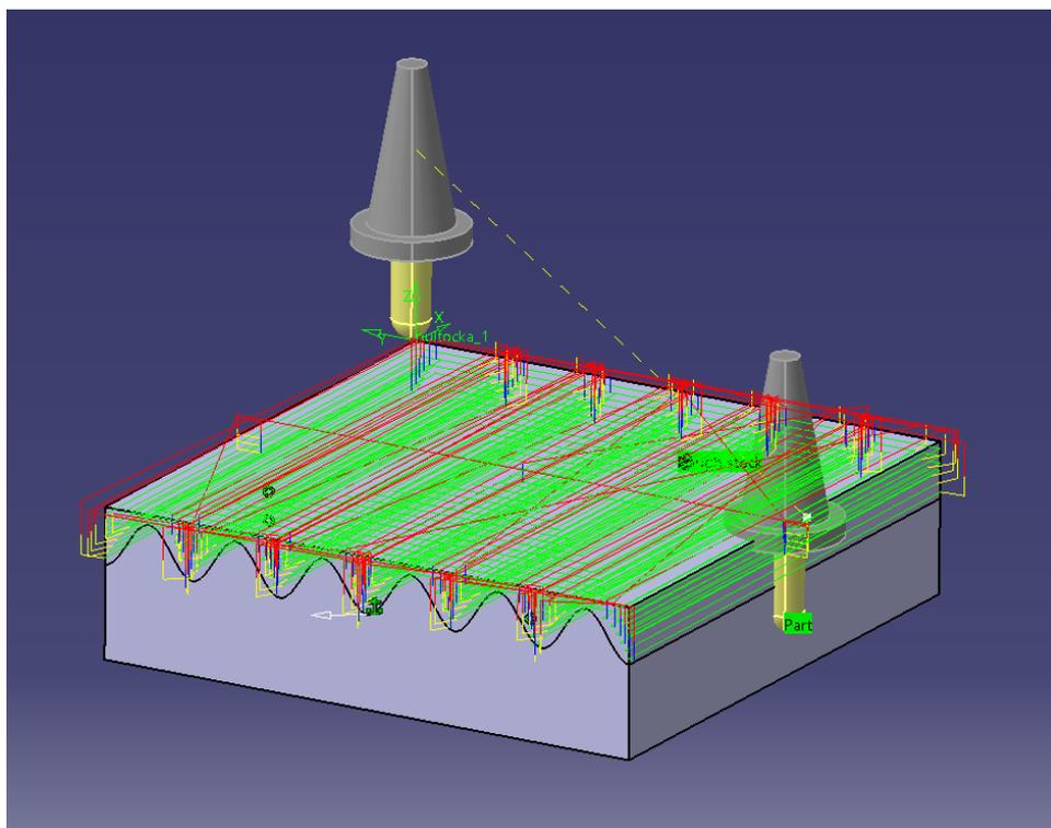
Slika 31 Prikaz putanje alata prizmatičnog grubog glodanja
