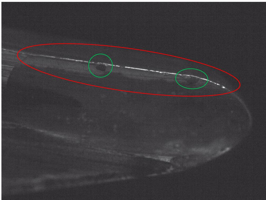
**Slika 41** Zaobljenje rezne oštrice 2– komercijali alat
