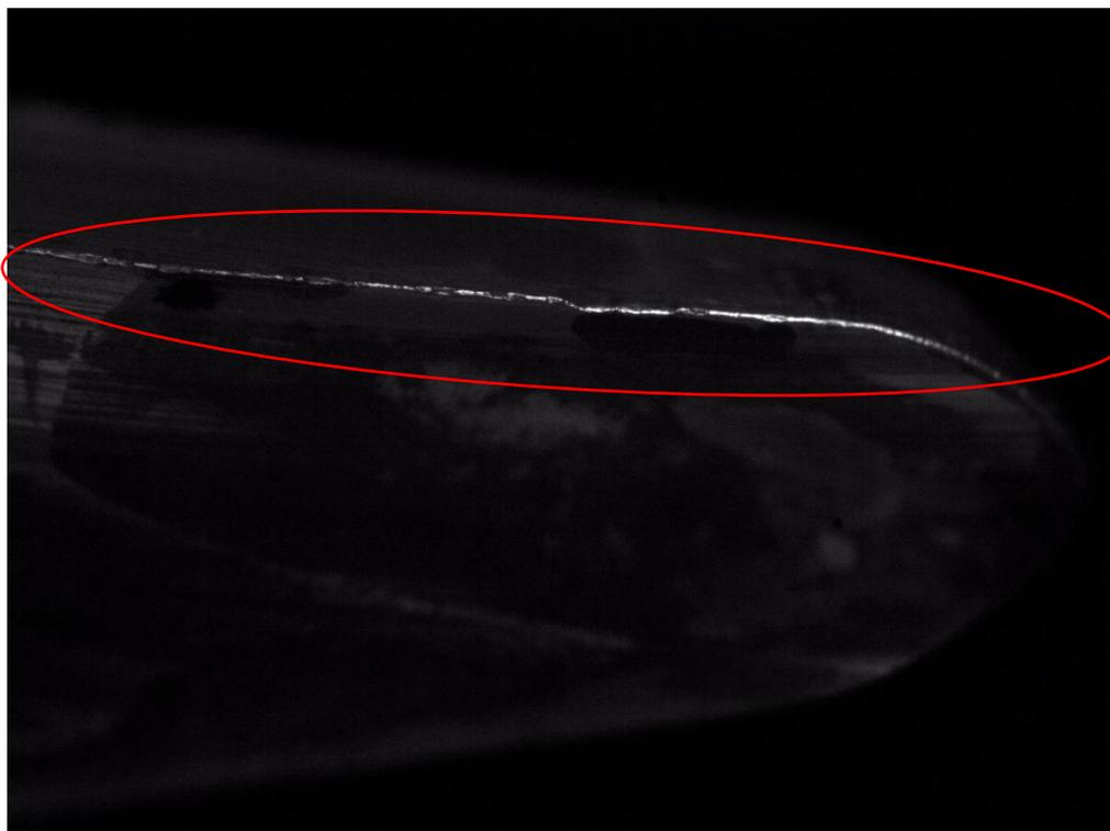
Slika 37 Zaobljenje rezne oštrice 1- komercijalni alat
