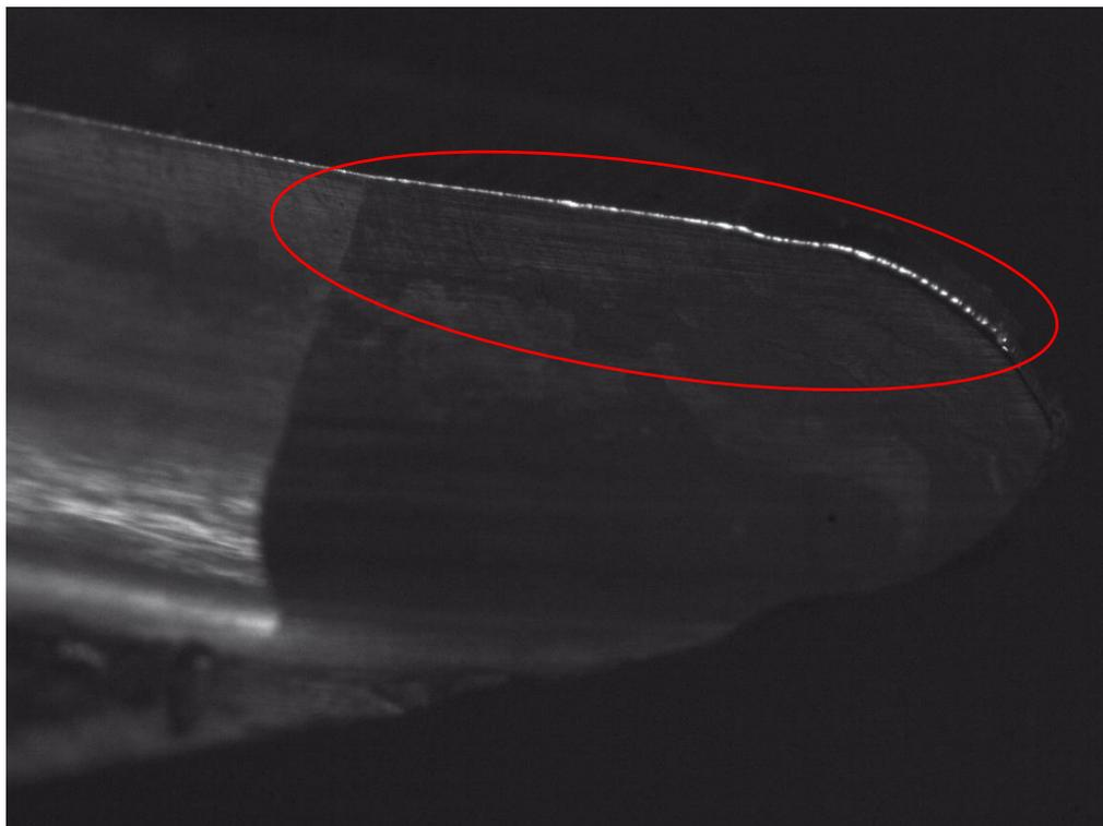
**Slika 35** Zaobljenje rezne oštrice 1 - NANO PRO
