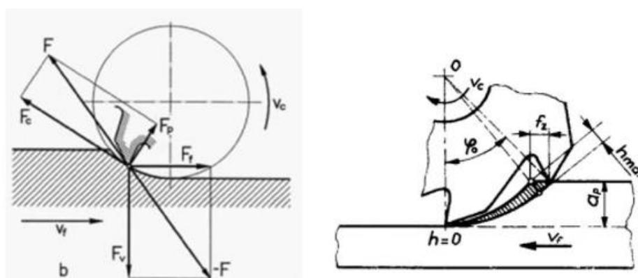
**Slika 10** Prikaz obodnog ravnog istosmjernog glodanja (lijevo sile koje djeluju na obradak, a desno parametri obrade) [15]
