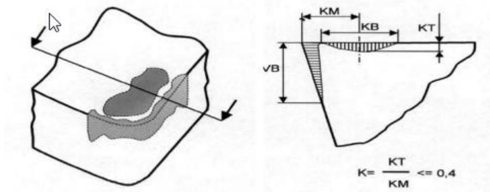
Slika 24 Parametri trošenja rezne oštrice alata [2]
