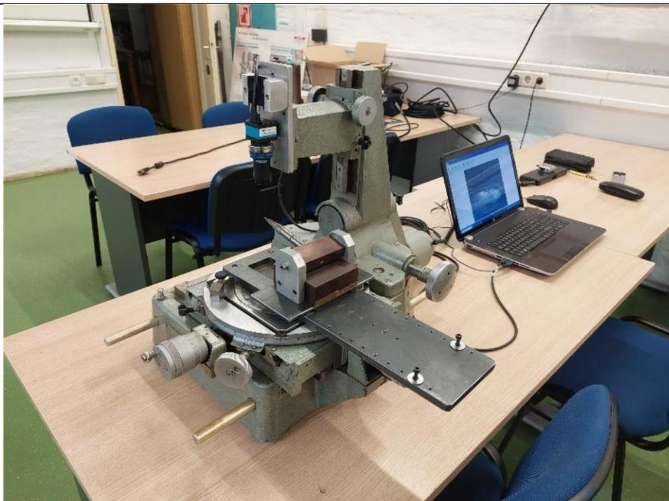
Slika 33 Postav za snemanje istrošenosti alata
