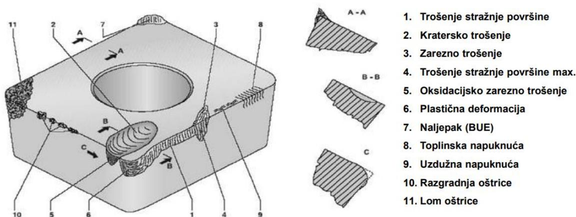
Slika 23 Položaji i oblici trošenja reznih alata [2]
