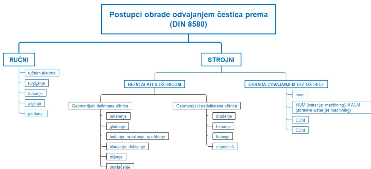
Slika 5 Podjela postupaka obrade odvajanjem čestica prema DIN 8580
