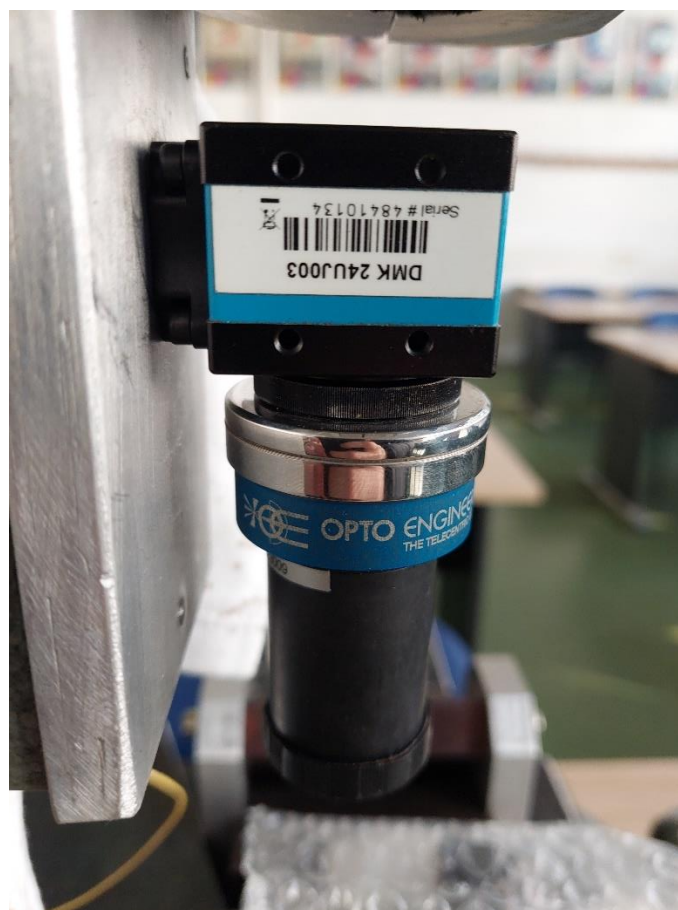
Slika 34 Industrijska kamera sa telecentričnim objektivom
