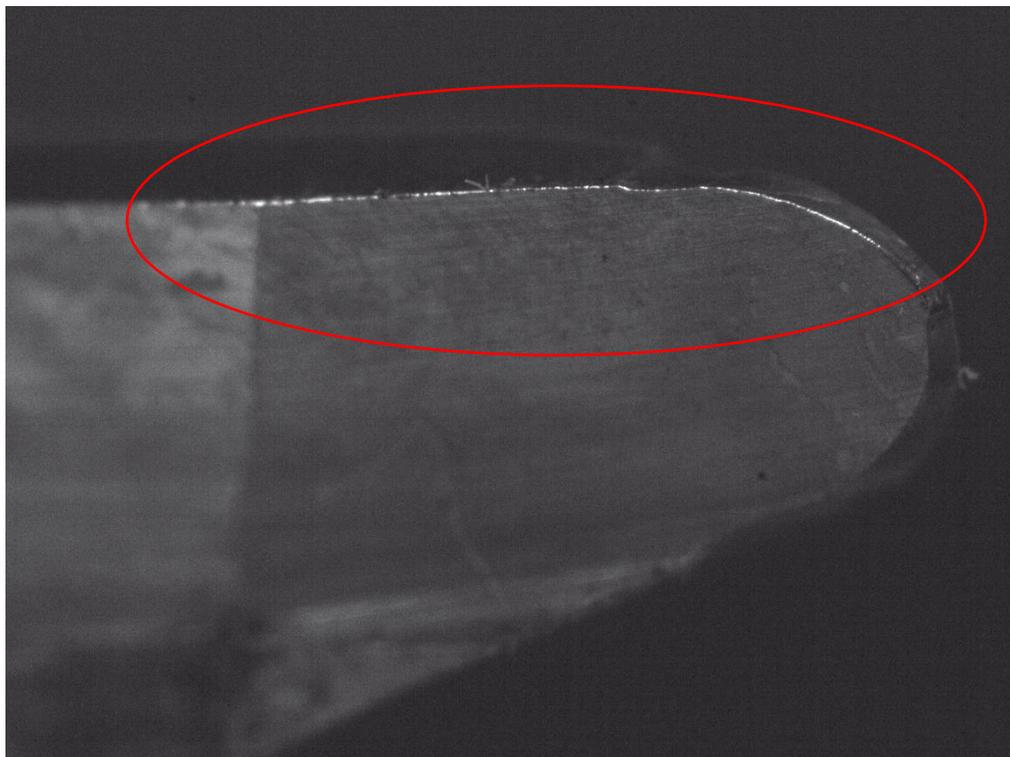
**Slika 39** Zaobljenje rezne oštrice 2 - NANO PRO
