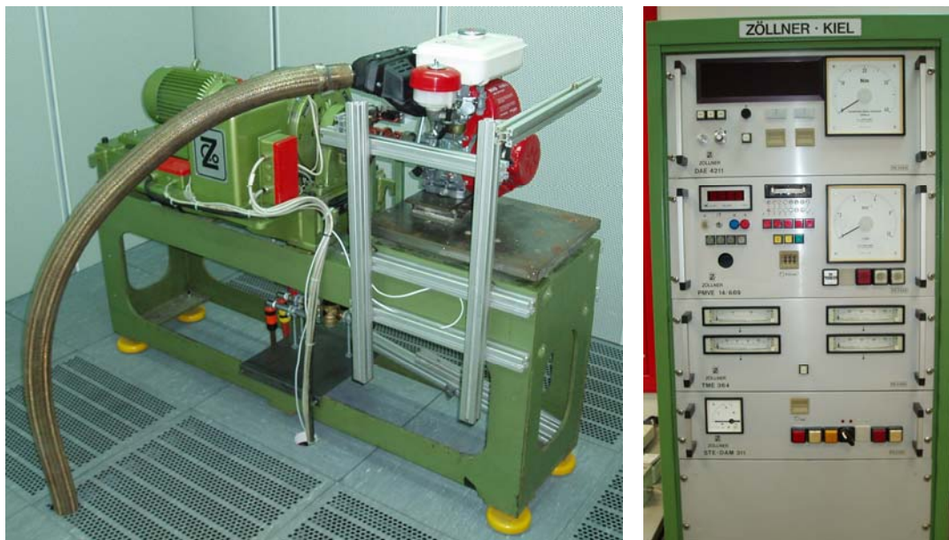
Slika 7.1. Kočnica za mjerenje snage Zollner A100 AC
