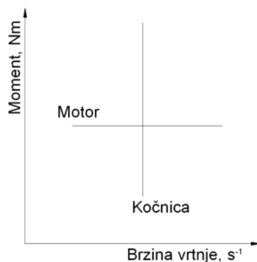
Slika 1.13. "Torque/speed" način ispitivanja
