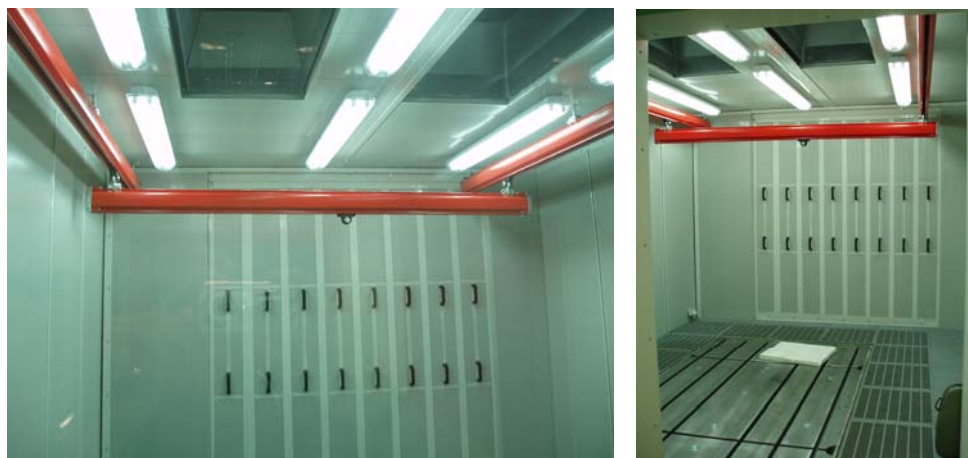
Slika 1.3. Ispitna kabina za motore većih snaga
