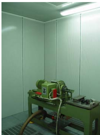
Slika 1.2. Ispitna kabina za motore manjih snaga
