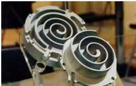
Slika 31. Fiksna i rotirajuća spirala spiralnog ekspandera [124]
