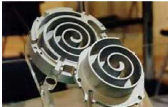
Slika 31. Fiksna i rotirajuća spirala spiralnog ekspandera [124]
