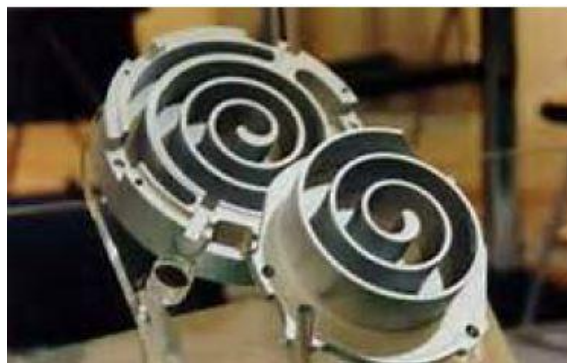
Slika 31. Fiksna i rotirajuća spirala spiralnog ekspandera [124]
