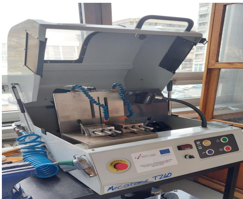
Slika 28. Uređaj za rezanje uzoraka
