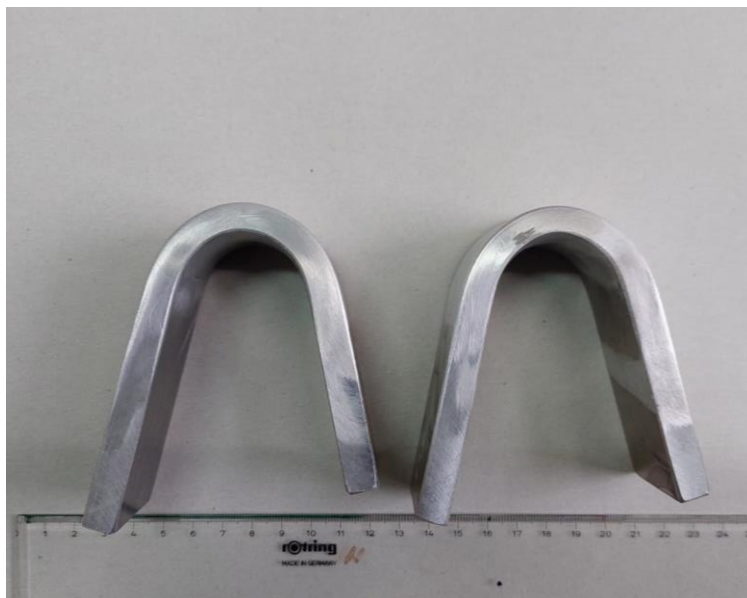
Slika 56. Poprečni presjek zavarenog spoja nakon savijanja
