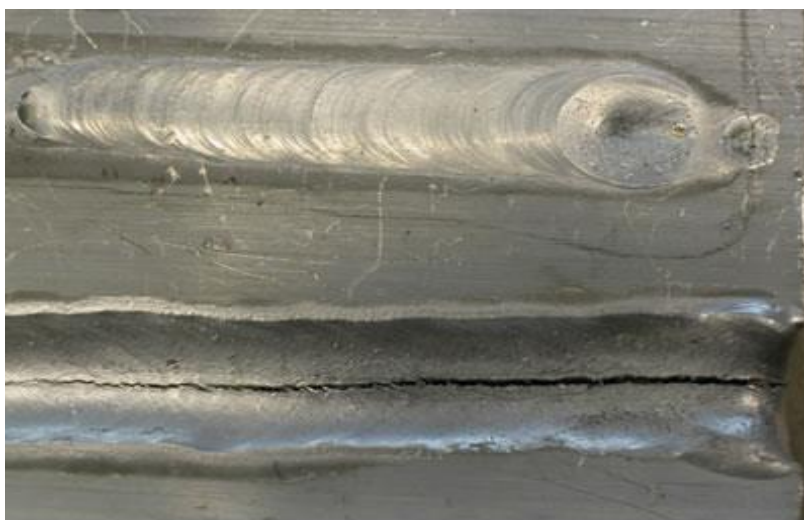
Slika 15. Pojava pukotina na zavaru nakon hlađenja [14]
