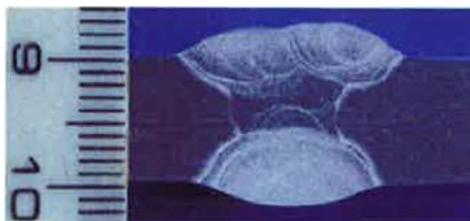
Slika 27. Uzorak za vizualno ispitivanje
