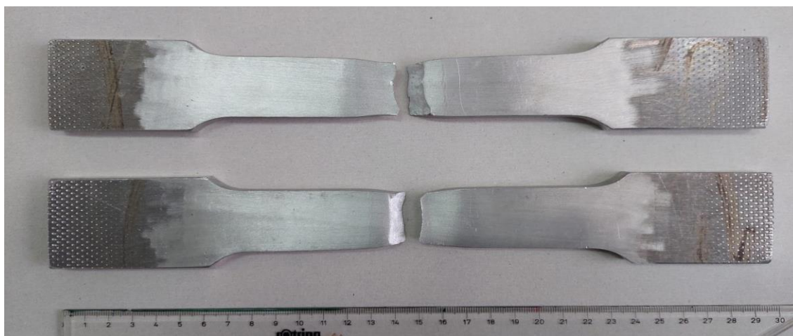
Slika 53. Uzorci nakon ispitivanja vlačne čvrstoće
