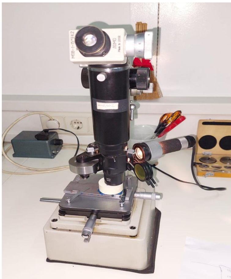
Slika 49. Uređaj za mjerenje mikrotvrdoće
