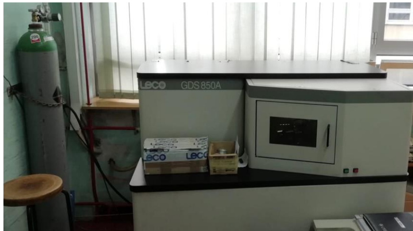
Slika 26. Prikaz spektrometra LECO GDS 850A za ispitivanje kemijskog sastava uzorka
