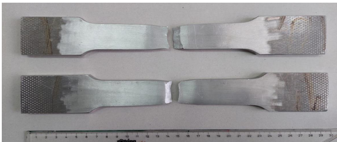
Slika 53. Uzorci nakon ispitivanja vlačne čvrstoće
