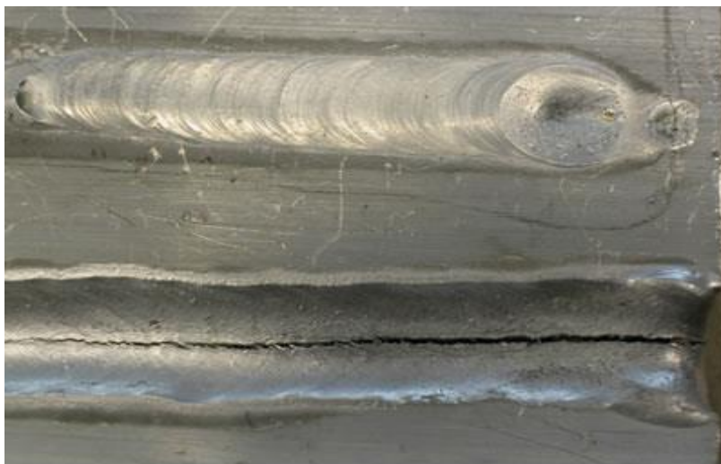
Slika 15. Pojava pukotina na zavaru nakon hlađenja [14]
