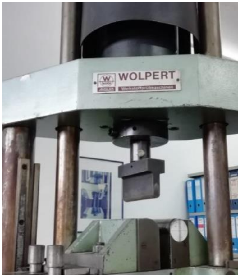
Slika 54. Izgled trna kojim se utiskuje pločica za savojno ispitivanje
