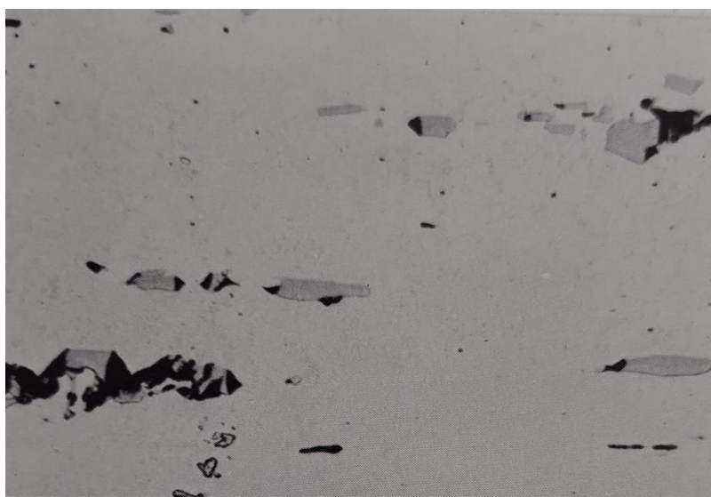
Slika 12. Mikrostruktura legure EN AW-5083 u poliranom stanju, snimljena pri povećanju 500× [12]
