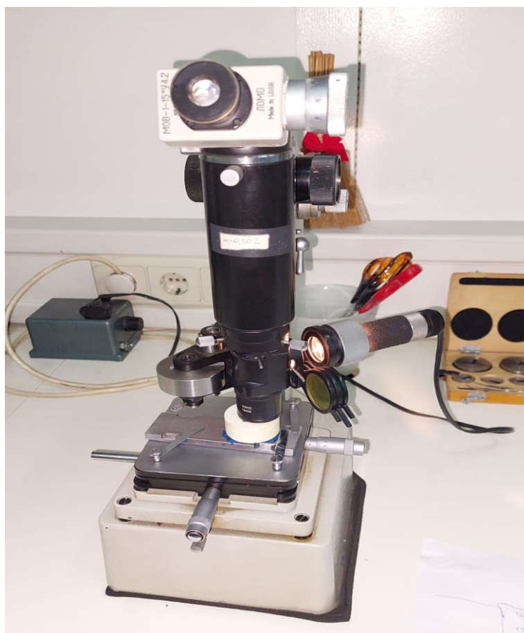
Slika 49. Uređaj za mjerenje mikrotvrdoće
