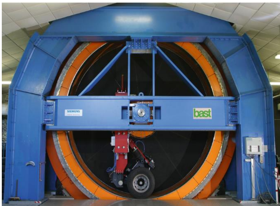
Slika 26. Uređaj za testiranje gume s unutrašnjim bubnjem, [8]
