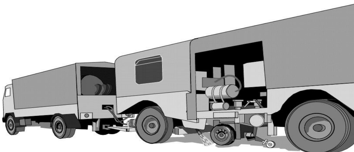
Slika 25. Uređaj za ispitivanje gume Tehničkog sveučilišta Delft, [7]
