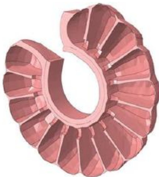
Slika 9. Aktuacija „sporog“ PneuNets aktuatora, [12]
