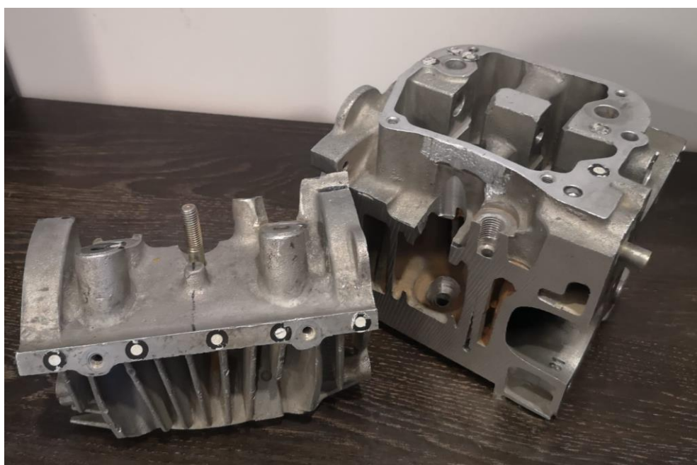
Slika 2. Prikaz glave motora hladene zrakom iz Laboratorija za motore i vozila
