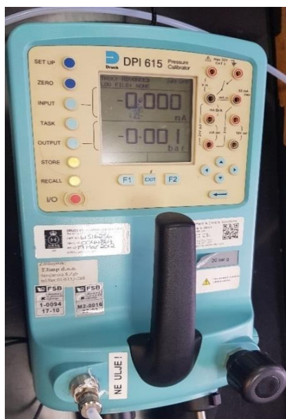
Slika 40. Regulator tlaka DPI 615 u ulozi multimetra
