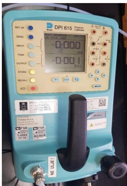
Slika 40. Regulator tlaka DPI 615 u ulozi multimetra
