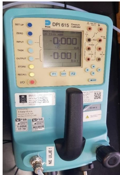
Slika 40. Regulator tlaka DPI 615 u ulozi multimetra
