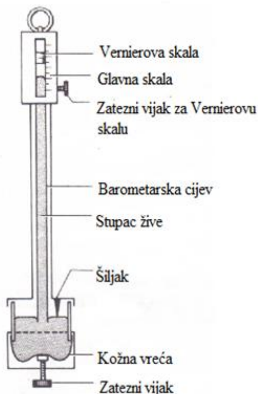
Slika 14. Shema Fortinovog barometra
