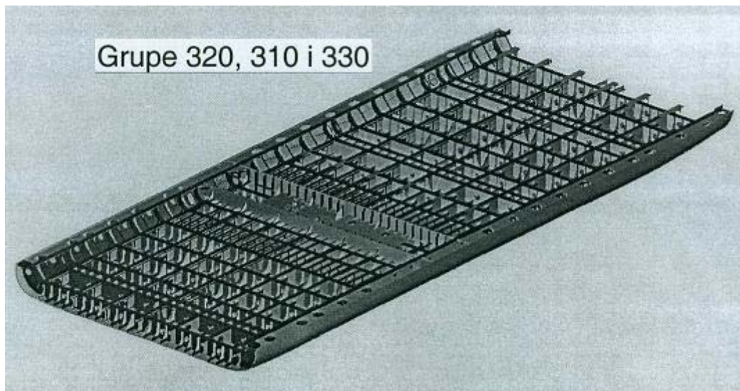
Slika 34 Montirane grupe dna broda u području pumpne stanice i blokova tankova tereta br. 2 i 3
