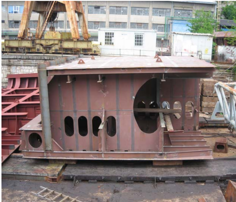
Slika 26 Sekcija dvodna ispod bloka tanka tereta br. 1
