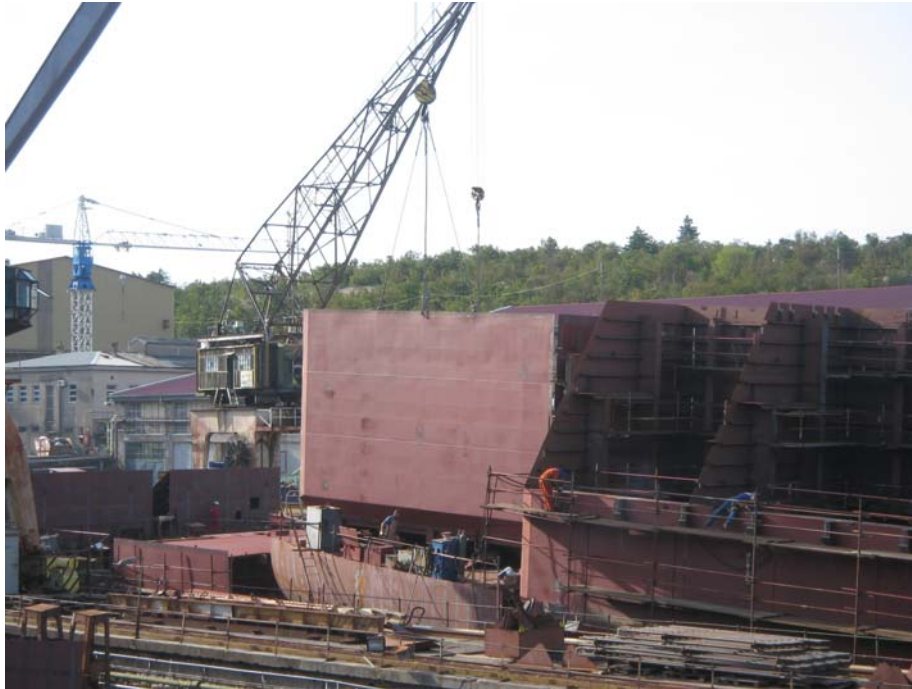
Slika 42 Montaža bloka tanka tereta br. 1 na navozu
