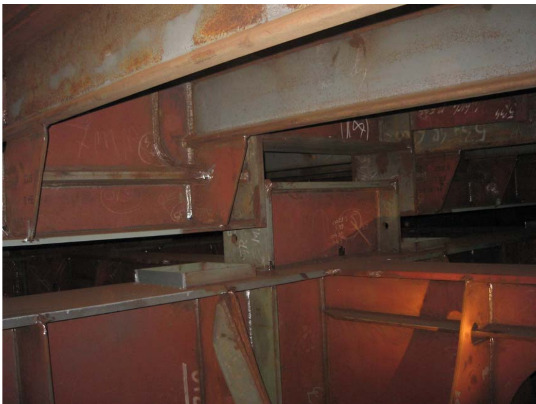
Slika 16 Ojačana struktura dna broda i dna tanka tereta u zoni protuljuljnog ključa
