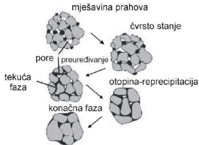
Slika 9. Faze zgušnjavanja prilikom sinteriranja u tekućoj fazi [1]
