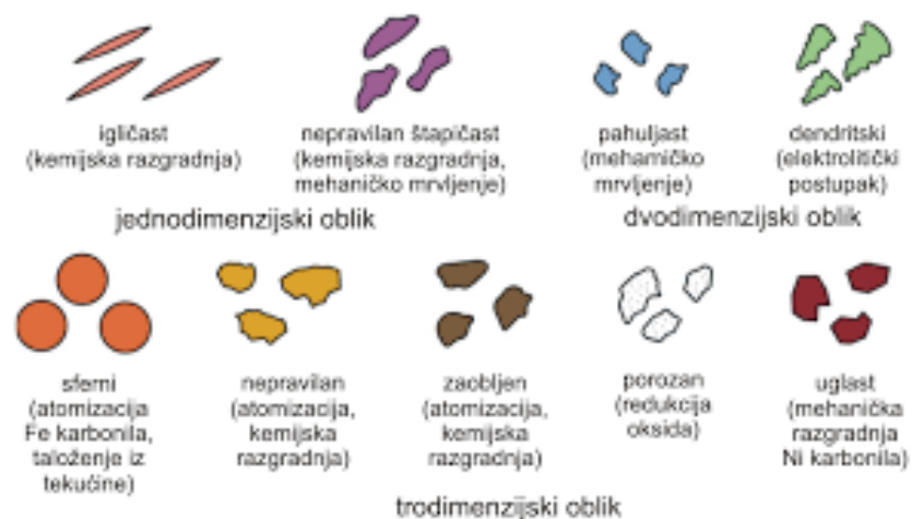
Slika 5. Oblik čestica praha i metode njihovog dobivanja [1]
