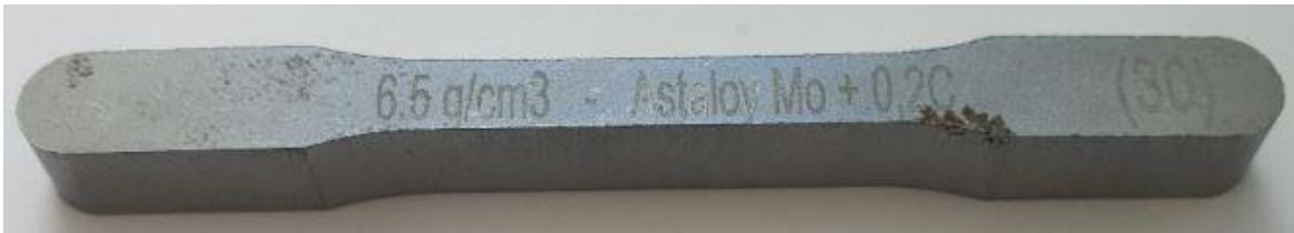
Slika 24. Epruveta od sinteriranog čelika Astaloy Mo+0,2C gustoće 6,5 \text{ g/cm}^3
