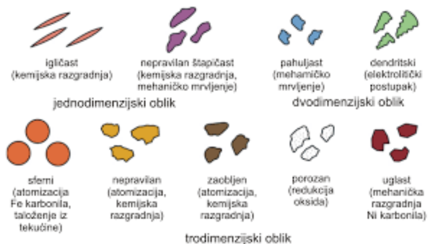
Slika 5. Oblik čestica praha i metode njihovog dobivanja [1]
