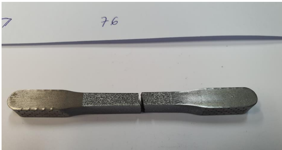
Slika 51. Lom epruvete kod eksperimentalnog ispitivanja
