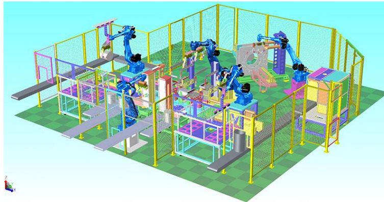
Slika 11. Sučelje simulacijskog softvera Yaskawa MotoSim [14]
