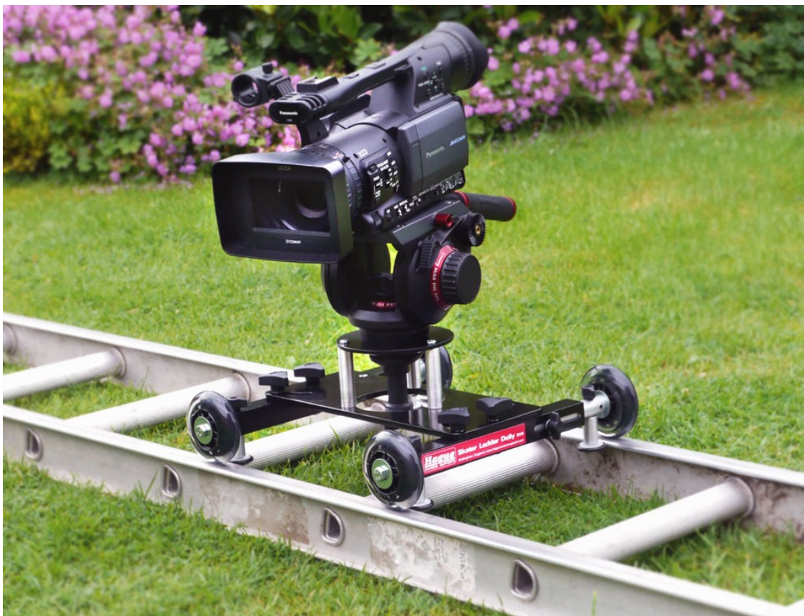
Slika 3 Kolica za kameru (eng. Dolly )
