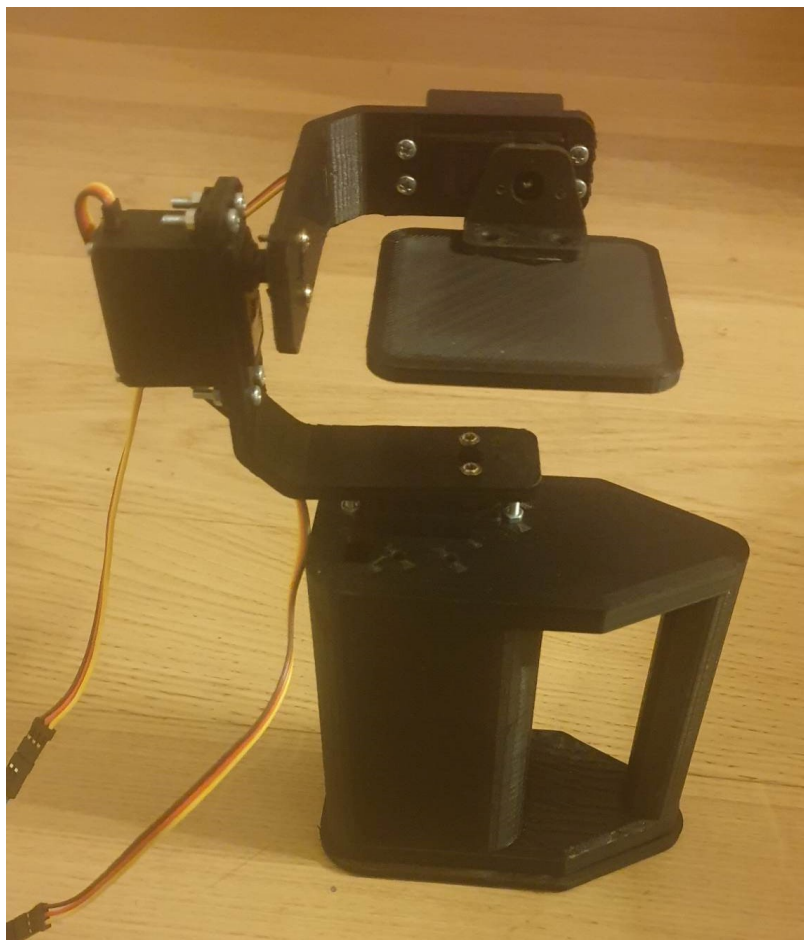
Slika 24 Konstrukcija troosne samostabilizirajuće platforme
