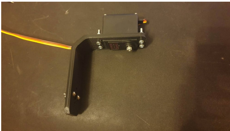
Slika 36 Spoj držača za servomotor i servomotora
