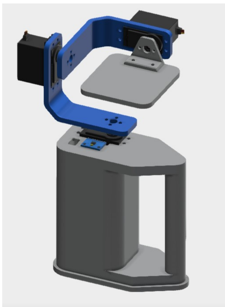
Slika 23 Model sklopa troosne samostabilizirajuće platforme
