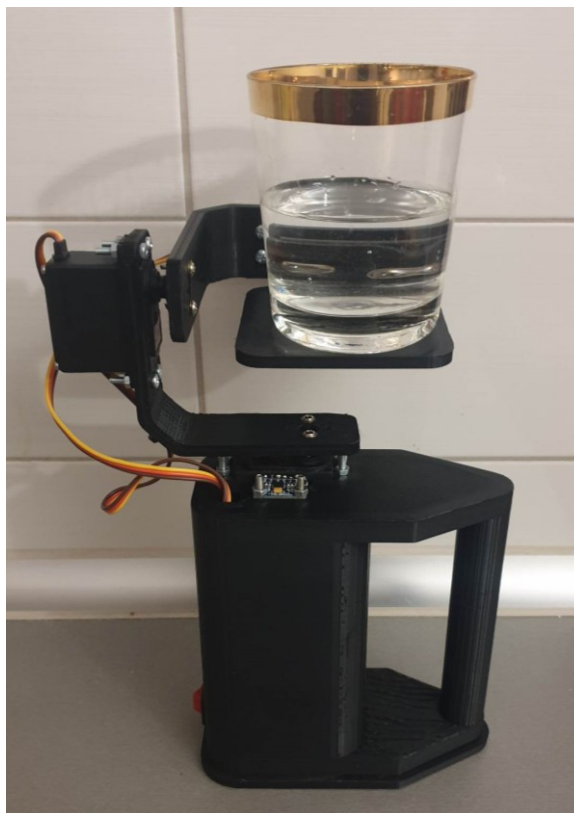
Slika 38 Troosna samostabilizirajuća platforma
