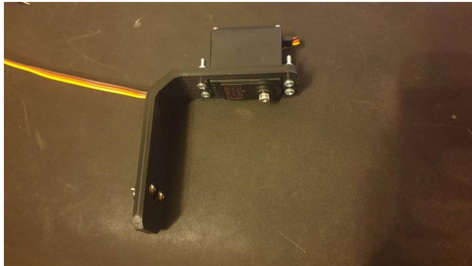
Slika 36 Spoj držača za servomotor i servomotora
