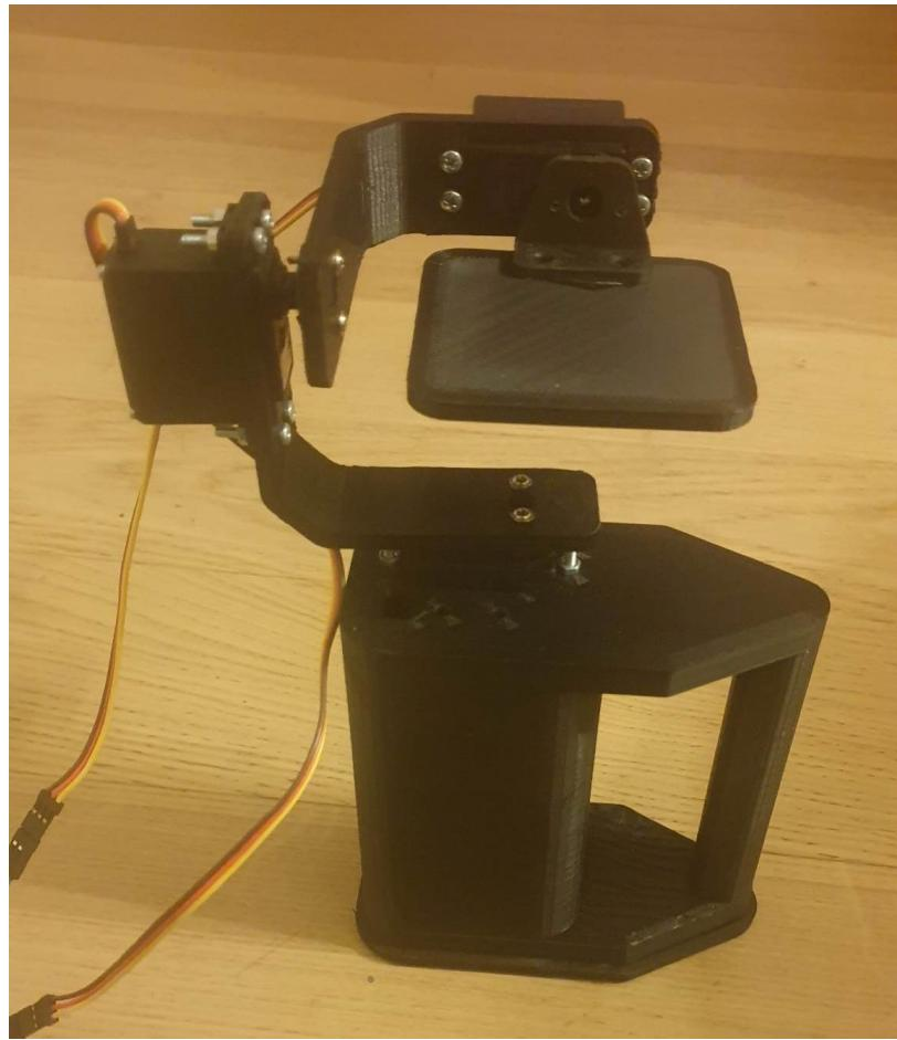
Slika 24 Konstrukcija troosne samostabilizirajuće platforme
