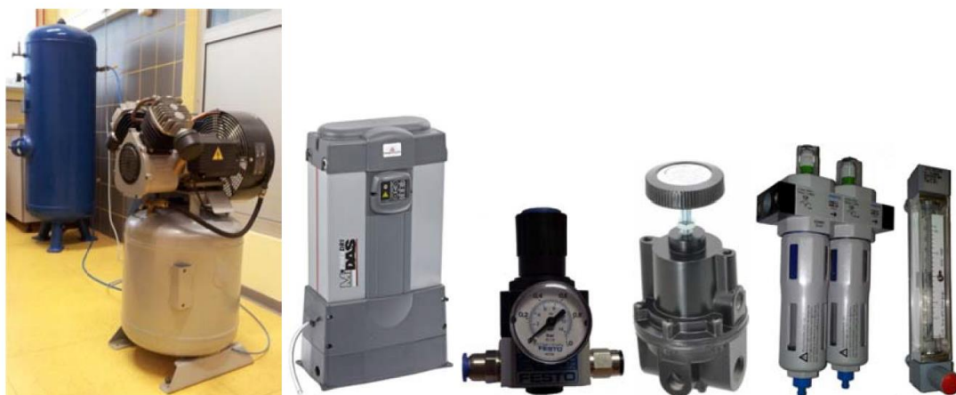
Slika 19. Komponente sustava za pripremu zraka [4]
